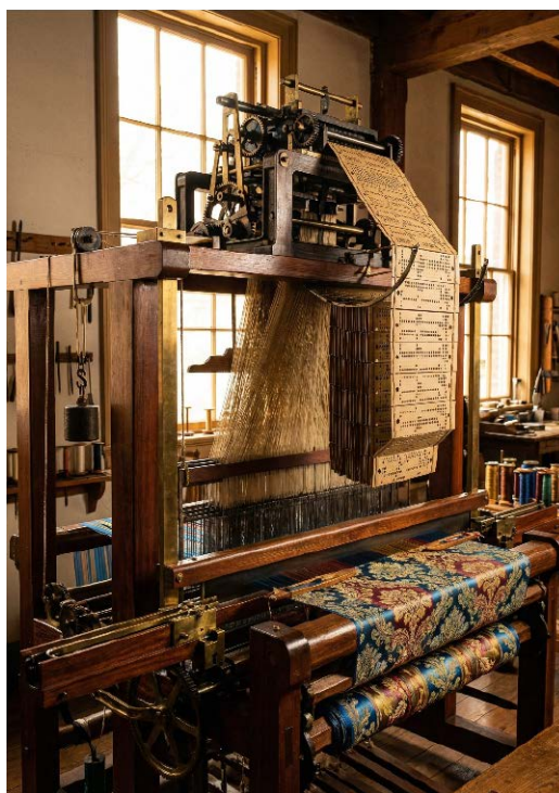
3. Model krosna Jacquarda z kartami perforowanymi – inspiracja dla mechanizmu programowania maszyny analitycznej Babbage'a
