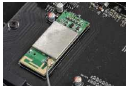
Na oddzielnej płytce umieszczono elektronikę strumieniową.
