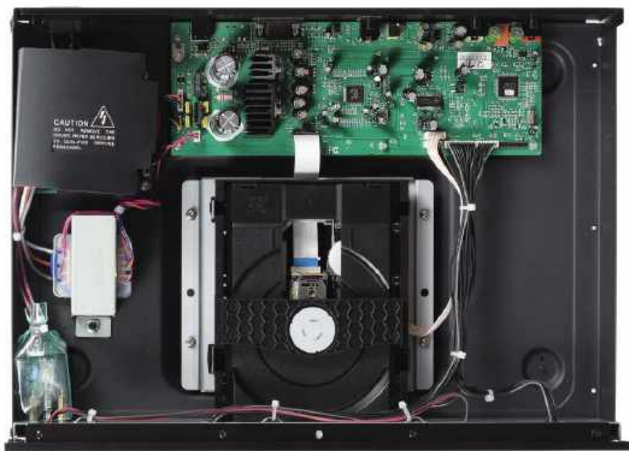
Liniowy zasilacz oparto na rdzeniowym transformatorze z kilkoma odczepami.
