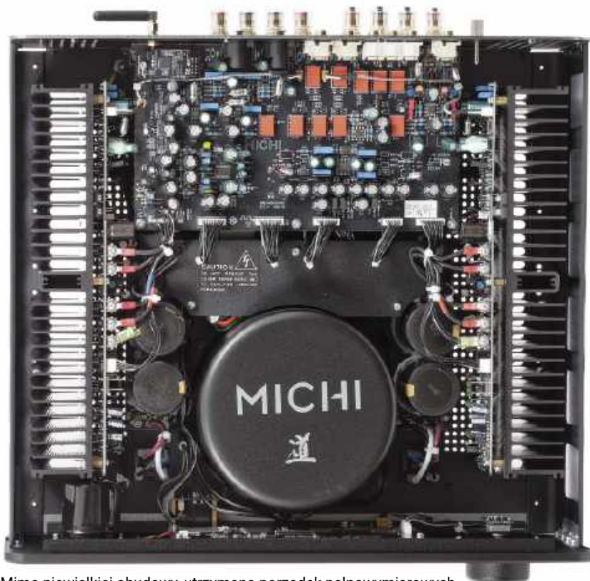
Mimo niewielkiej obudowy, utrzymano porządek pełnowymiarowych urządzeń Michi, z końcówkami mocy w klasie AB i liniowym zasilaczem.
