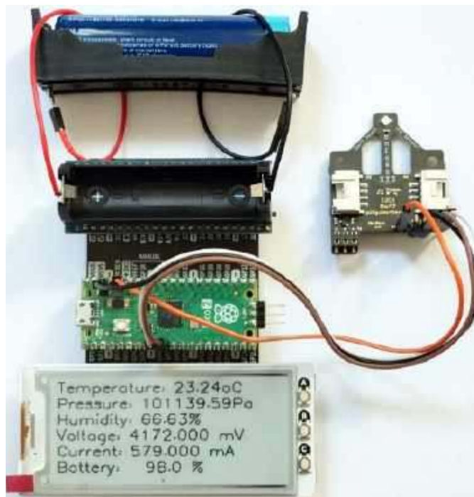
Fotografia 2. Płytkę Pico-UPS-A dołączoną do ekspandera Pico
