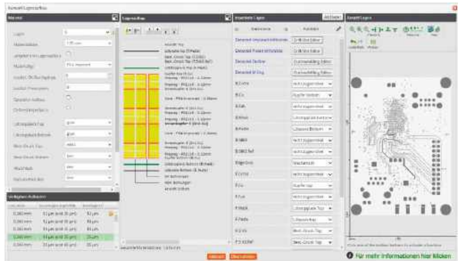
Rysunek 1. Edytor Buildup to inteligentne narzędzie zawarte w Visualizerze, które zawiera wszystkie opcje produkcyjne i proponuje wskazówki dla najlepszej optymalności
