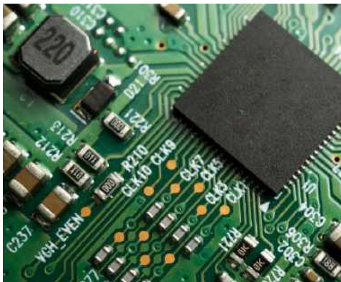
Fotografia 10. Punkty testowe w pobliżu układu scalonego [13]
