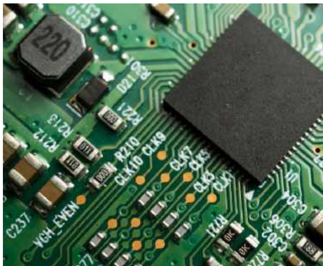
Fotografia 10. Punkty testowe w pobliżu układu scalonego [13]
