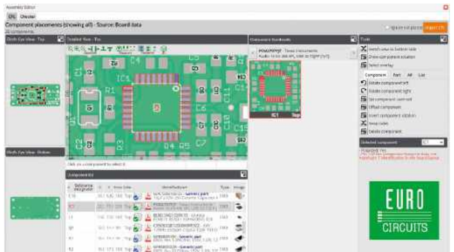
Rysunek 3. Narzędzie Visualizer Tool Assembly Checker rozpoznaje komponenty o odwrotnej polaryzacji; w tym przypadku błędna jest pozycja pinu nr 1
