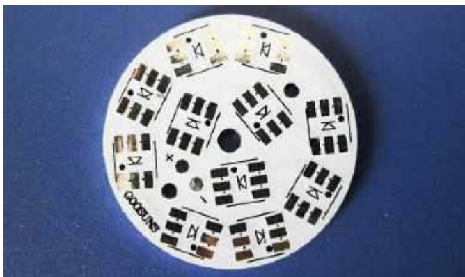
Fotografia 5. Laminat na podłożu aluminiowym [5]
