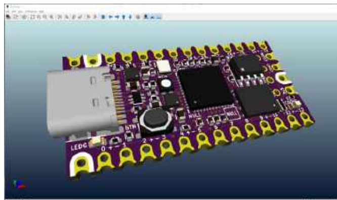
Rysunek 4. Widok 3D płytki drukowanej w programie KiCad ( https://t.ly/2NFPH )
