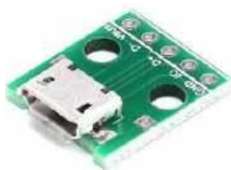
Fotografia 1. Przykładowy moduł ze złączem Micro USB ( https://t.ly/21DYA )
