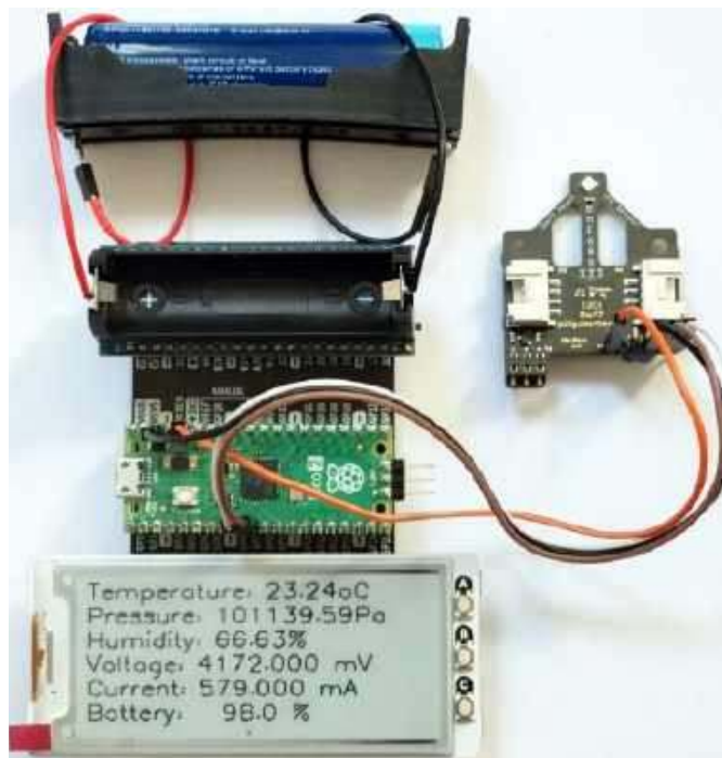
Fotografia 2. Płytkę Pico-UPS-A dołączoną do ekspandera Pico
