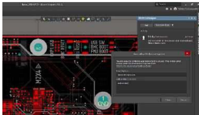
Rysunek 5. Narzędzie Altium MCAD CoDesigner pozwala za pomocą dwóch kliknięć przestać zmiany w projekcie fizycznym PCB do konstruktora mechanika, pracującego w osobnym środowisku CAD ( https://t.ly/3XtA4 )
