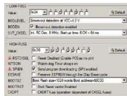
Rysunek 3. Szczegóły ustawienia bitów zabezpieczających
