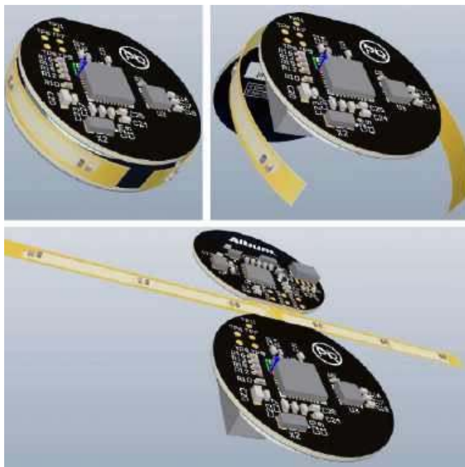
Rysunek 7. Altium Designer zapewnia pełne wsparcie w zakresie projektowania obwodów rigid-flex, włącznie z symulacją stopniowego zwijania układu do pozycji docelowej ( https://t.ly/46fAu )
