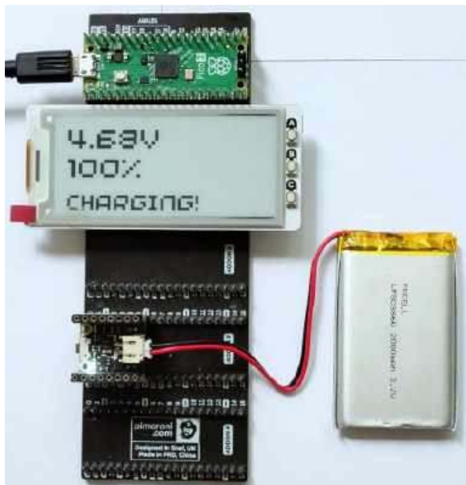
Fotografia 1. Płytkę Li-Po SHIM dołączoną do ekspandera Pico Decker
