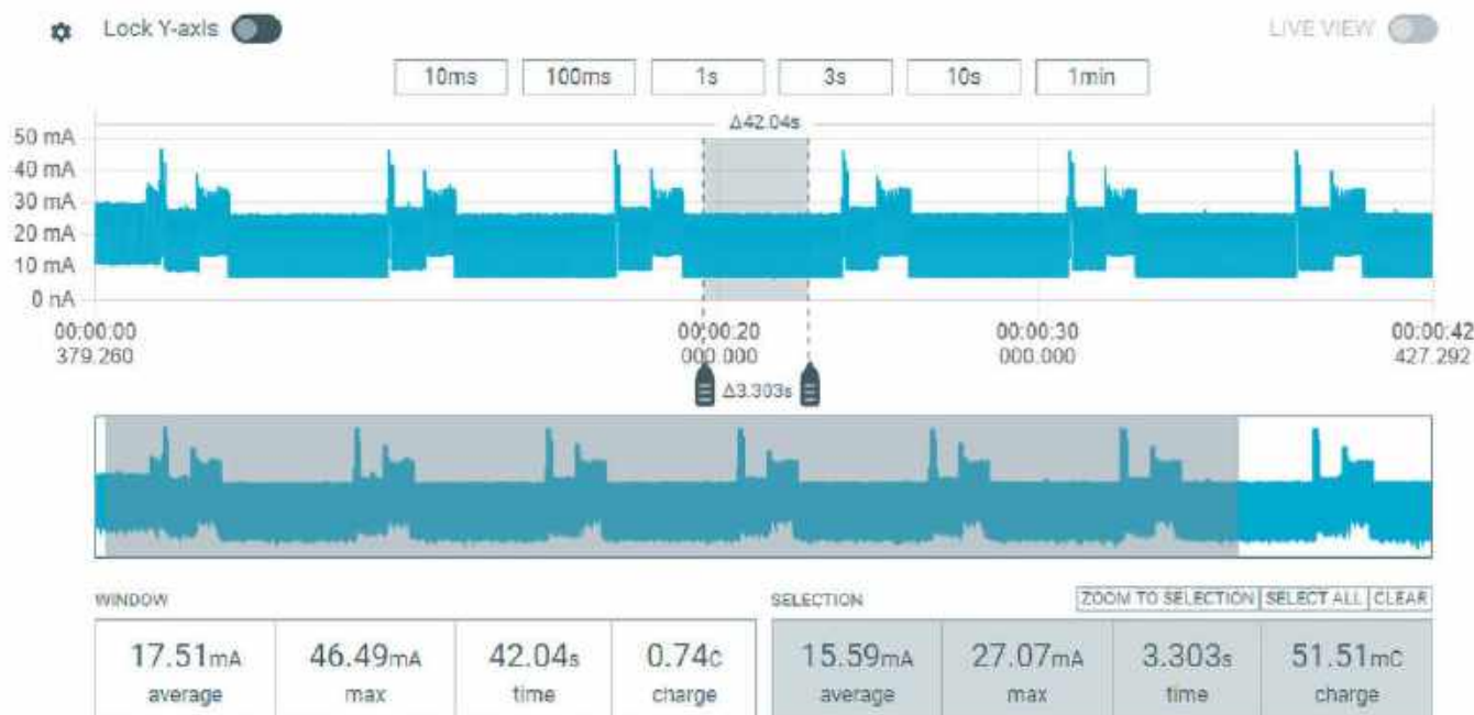
Rysunek 3. Pomiar prądu akumulatora
