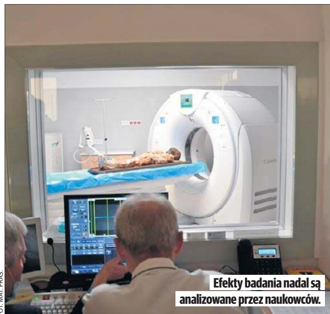
Badania mumii wykonano przy użyciu 80-rzędowego tomografu komputerowego.
