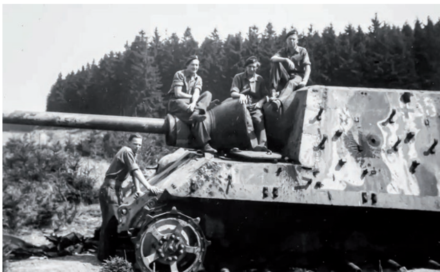
◀ W Putlosie znaleziono także dwa wraki ciężkich niszczycieli czołgów Jagdtiger (uzbrojenie stanowiła armata kalibru 128 mm). Na płycie kadłuba widoczny jest krzyż belkowy i numer taktyczny „55” oraz ślady po trafieniach.
