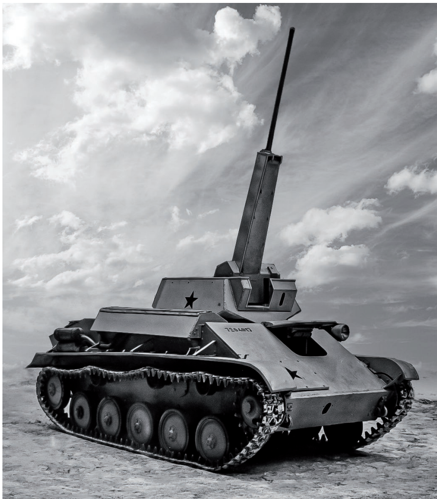
▲ Czołg przeciwlotniczy ZUT z armatą ustawioną na maksymalnym kącie podniesienia. Na tym zdjęciu dobrze widać opancerzenie przedniej części kołyski, zawieszenie armaty i przedniej ściany wieży. Gwiazdy na kadłubie i wieży być może pochodzą z jakiegoś pokazu dla władz partyjnych i wojskowych.
