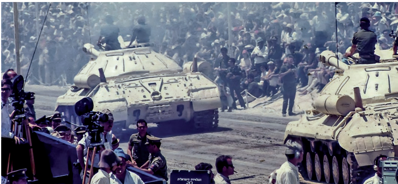
▼ Izraelskie czołgi IS-3 UKN uczestniczące w paradzie wojskowej w Jerozolimie w maju 1968 r. Widoczne są izraelskie modyfikacje obejmujące układ wydechowy oraz gniazdo anteny na wieży.
