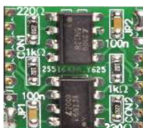
Z Silicon Chip-a nr 3/2021 – to izolowane łącze szeregowe jest idealne do połączenia ze sobą dwóch płytek balansujących.
