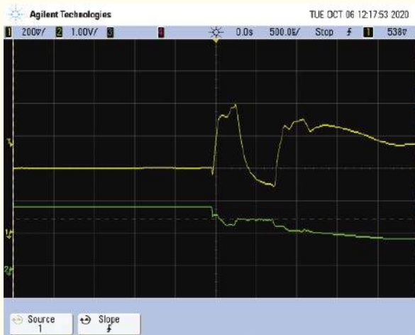
Oscylogram 1. Reakcja na wzrost obciążenia, który wyzwała ograniczenie prądu. Żółty przebieg to napięcie na rezystorze pomiarowym, więc jest proporcjonalne do prądu, podczas gdy zielony przebieg jest proporcjonalny do napięcia wyjściowego. Występuje pewne przekroczenie prądu, głównie z powodu pojemności na wyjściu, po czym włącza się ograniczenie prądu, zmniejszając napięcie wyjściowe, aby osiągnąć stan ustalony w ciągu 1 ms
