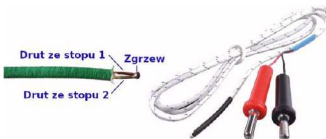
Typowy przykład termopary dostarczonej z multimetrem (© 2023 Jos Verstraten)
