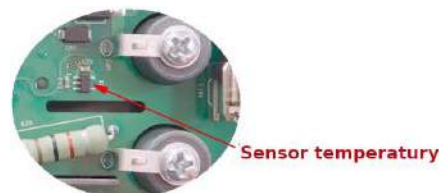
Czujnik kompensacji zimnego złącza (© lygte-info, pod redakcją Josa Verstratena)
