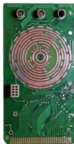
Konstrukcja przełącznika (© 2023 Jos Verstraten)
