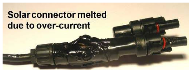
Fotografia 3. Przykład uszkodzenia termicznego izolacji złącza fotowoltaicznego, spowodowanego przekroczeniem prądu maksymalnego (https://t.ly/9dyF)
