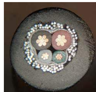
Fotografia 9. Przekrój typowego kabla USB 2.0 ( https://t.ly/YBJJ )
