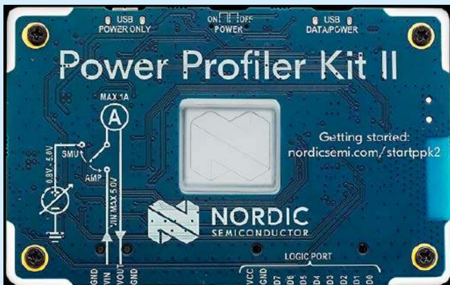
Fotografia 1. Wygląd płytki PPK2 (widok z góry) [3]
