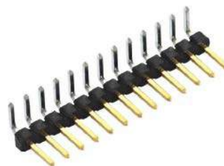
Fotografia 6. Złącze rastrowe z cynowaniem selektywnym ( https://t.ly/Kw9U )
