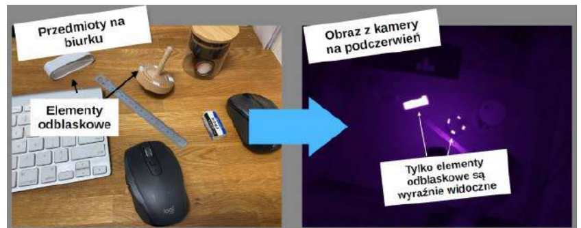
Rysunek 3. Bierko autora obserwowane w świetle widzialnym (po lewej) i podczerwieni (po prawej). Widoczne na obrazie reflektory podczerwieni zapewniają bardzo duży kontrast przy obserwacji IR
