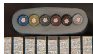
Fotografia 14. Przekrój płaskiego kabla telefonicznego (https://t.ly/Oewd)
