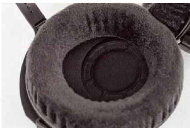
Przetworniki Tesla ustawiono pod kątem (w stronę tyłu głowy).
