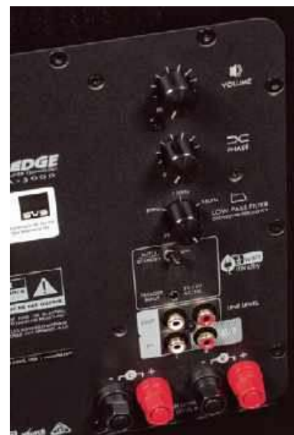
Wyjątkowym elementem wyposażenia SB-1000 jest wyjście sygnału filtrowanego górnoprzepustowo (druga para RCA). Są też wejścia głośnikowe (RCA oczywiście też) – to subwoofer wyjątkowo „komunikatywny”.
