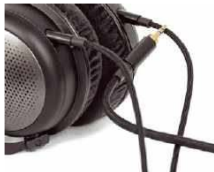
W zestawie jest jeden przewód z miękką i tłumiącą izolacją; w głównej części kabel jest spleśzczony.
