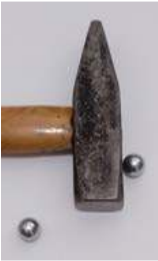
Fot. 1. Wykorzystanie obucha młotka, jako płyty prostokątnej do badania zderzeń.
