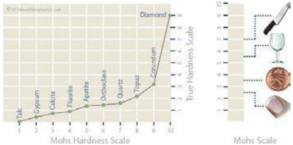
Rys. 3. Bardzo użyteczna, względna skala twardości Mohsa: materiał twardszy zostawia rysę na materiale miększym: twarda stal rysuje szkło a piasek (kwarc) rysuje stal. Paznokiec ma twardość ok. 2,5, czyli można nim zarysować gipsową ścianę, miedź ma 3,5, szkło 5,5, pilnik do paznokci ok. 6,5. (AllAboutGemstones.com, dostęp 2012)
