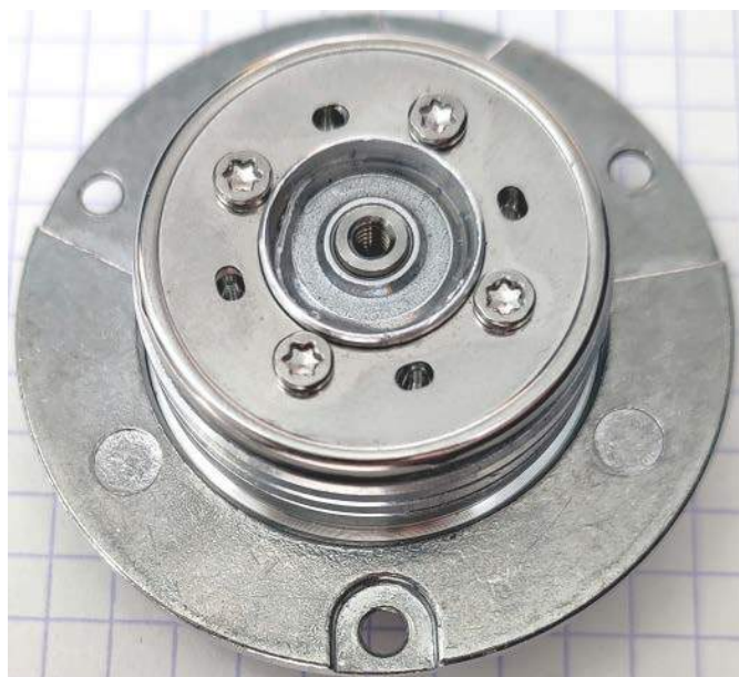
Fotografia 1. Silnik BLDC z napędu talerzy dysku twardego (HDD)
