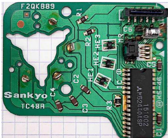
Fotografia 10. Płytką drukowaną zawierającą sterownik silnika bezszczotkowego oraz pełniącą funkcję podstawy konstrukcyjnej dla całego napędu. Warto zwrócić uwagę na cztery konektory, wlotowe na wokół wycięcia po lewej stronie PCB: prawy dolny konektor jest niepodłączony do reszty układu i odgrywa rolę wewnętrzznego wężła uzwojeń, wykonanych w topologii gwiazdy (oprac. własne autora)
