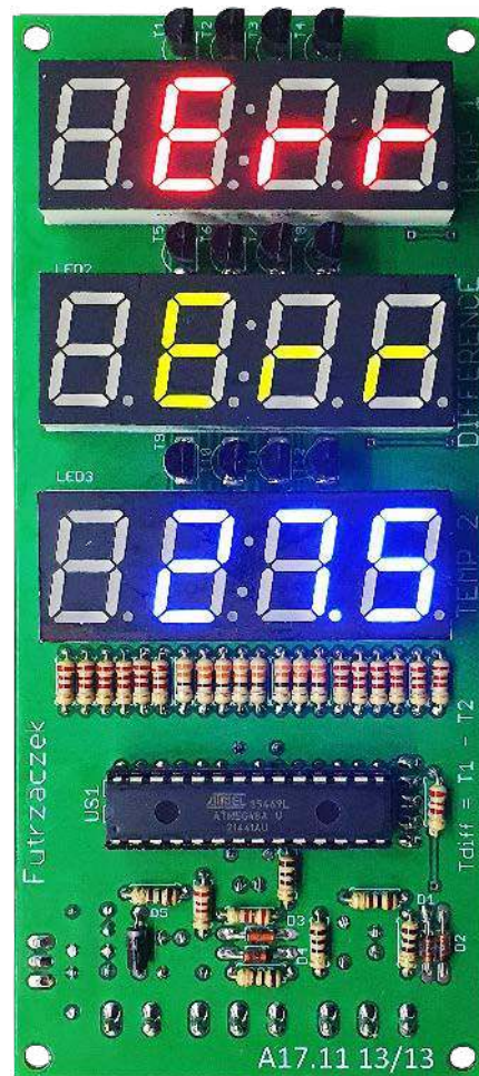
Fotografia 2. Wygląd wyświetlacza z komunikatem błędą czujnika
