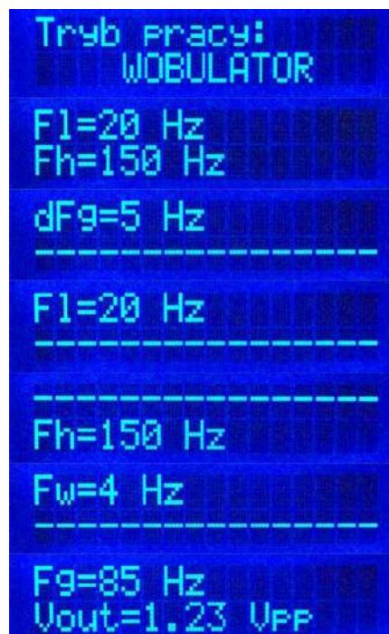
Fotografia 9. Ekran wyświetlany w trybie wobulatora
