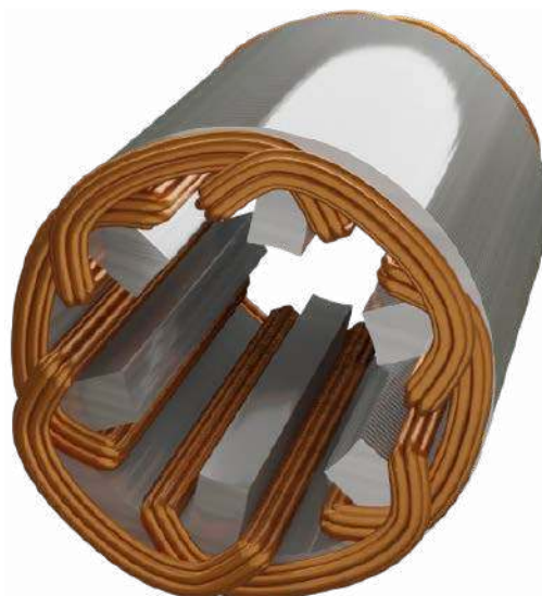
Rysunek 17. Uproszczona budowa rdzenia silnika BLDC z uzwojeniami zachodzącymi na siebie ( t.ly/MsRu )
