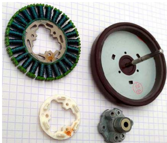
Fotografia 12. Elementy konstrukcyjne silnika, którego płytkę przed- stawiono na fotografiach 10 i 11: na górze od lewej – rdzeń z uzwo- jeniami i rotor zewnętrzny z wałem napędowym, na dole od lewej: tworzywowy element montażowy z wycięciami pod konektory oraz zespół łożyska ślizgowego
