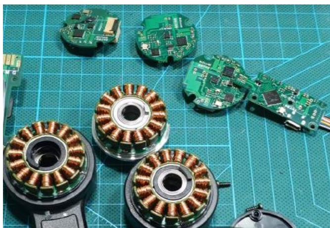
Fotografia 6. Elementy komercyjnego gimbału przeznaczonego do smartfonów. Widoczne trzy płytki kontrolerów BLDC oraz statory silników, odpowiedzialnych za ruch poszczególnych osi (t.ly/MrRL)
