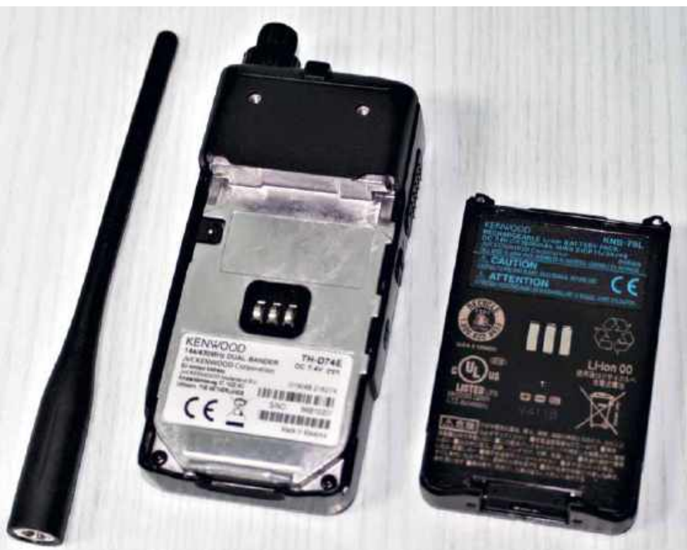
Rys. 2. TH-D74E, widok od tyłu oraz bateria KNB-75L (1800 mAh) i oryginalna antena. Egzemplarz na zdjęciu został poddany wnikliwym testom opisanym w artykule
