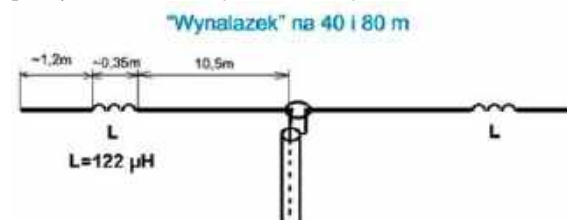
Rys. 4. Szkic konstrukcji anteny dwupasmowej 40/80 m wg SP8BWR
