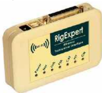
WTI-1 firmy Rigexpert zapewnia połączenie radiostacji z komputerem z dowolnego miejsca w domu czy mieszkaniu przez lokalną sieć Wi-Fi
