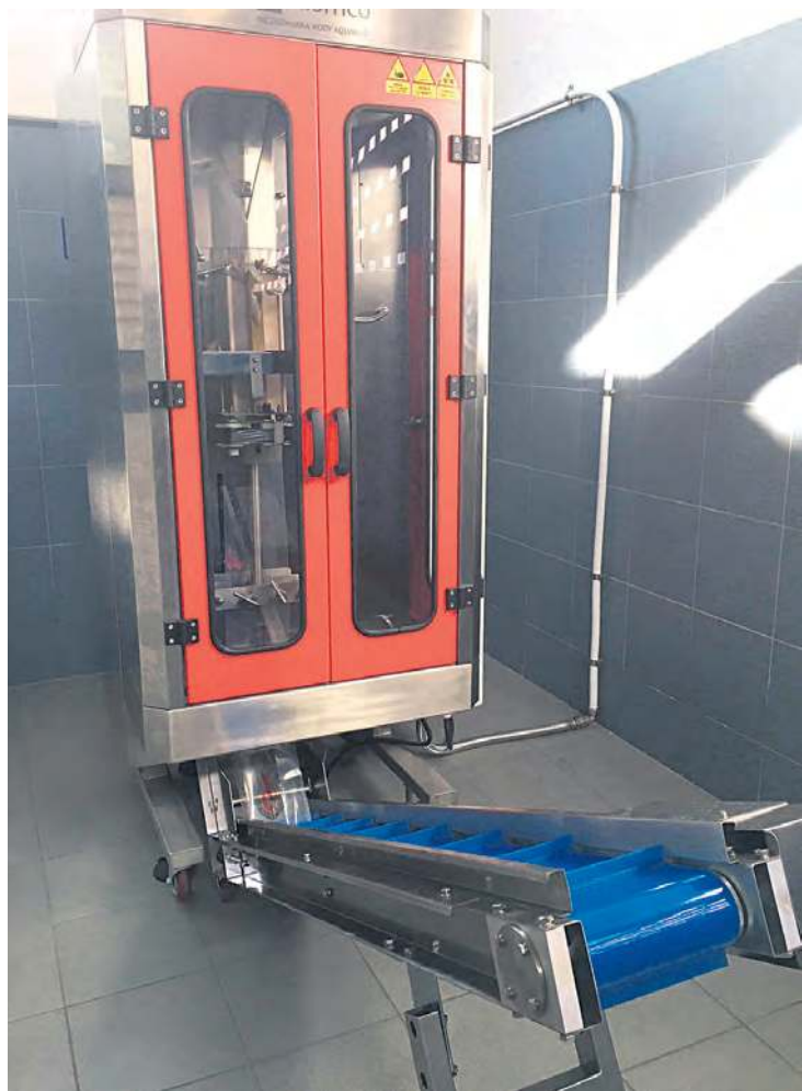
Paczkowarka do wody wykorzystywana w nowosądeckich wodociągach.
