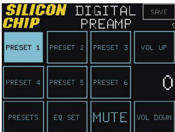
Ekran 1. Ekran główny posiada przyciski do szybkiego wczytania jednej z sześciu nastaw, zmiany głośności, wyciszenia wyjścia lub przejścia do jednego z dwóch ekranów ustawień (ustawienia wstępne i regulacja tonów/EQ)
