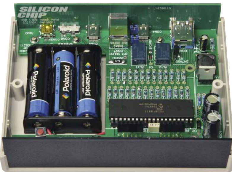
Gotowy tester kabli USB sfotografowany z przodu i z tyłu. Na fotografiach widać, że wszystkie połączenia są wykonywane z przodu obudowy. Jeden przycisk jest uniesiony, dzięki czemu można uzyskać do niego łatwiejszy dostęp przez otwór w pokrywie.
