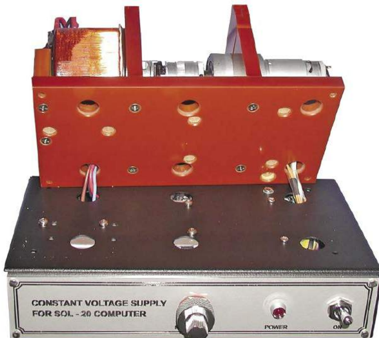
Otwory wywiercone w fenolowej podstawie i górnej pokrywie obudowy umożliwiają przejście okablowania między nimi oraz zapewniają przepływ powietrza do obudowy poniżej
