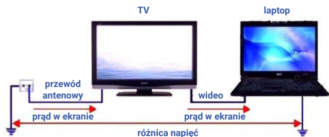
Tworzenie pętli uziemienia podczas podłączania komputera do urządzenia AV (© 2017 Jos Verstraten)
