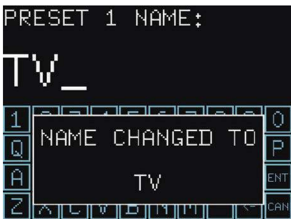
Ekran 5. Naciśnięcie przycisku „Enter” (Ent) powoduje potwierdzenie nowej nazwy wprowadzonego ustawienia wstępnego
