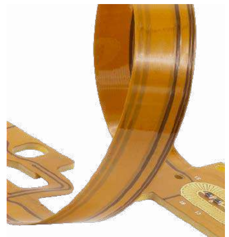
Fotografia 1. Elastyczny obwód jednowarstwowy
