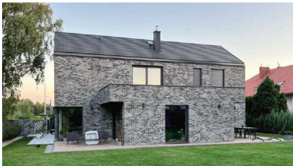
🔵 🟡 Płytki mineralne są cienkie, giętkie i znacznie lżejsze od tradycyjnego klinkieru, dlatego dobrze sprawdzają się na ocieplonych ścianach, również na systemach ze styropianem lub wełną mineralną. ELASTYCZNY KLINKIER / ELASTOLITH, ELKAMINO DOM
