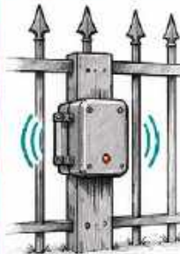
CZUJNIK WIBRACYJNY NA OGRODZENIU
