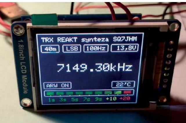
Ekran kolorowy o przekątnej 1,8" jest częścią syntezeru
