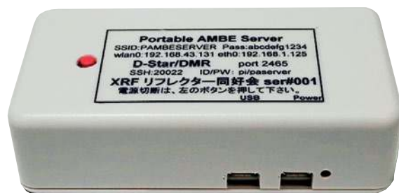
Fot. 3. Portable AMBE Server składa się z Maliny i dodatkowej płytki wokodera
