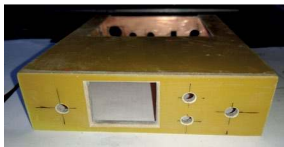
Sposób wykonania obudowy z laminatu
