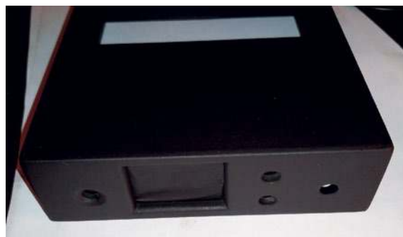
Gotowa obudowa po malowaniu
