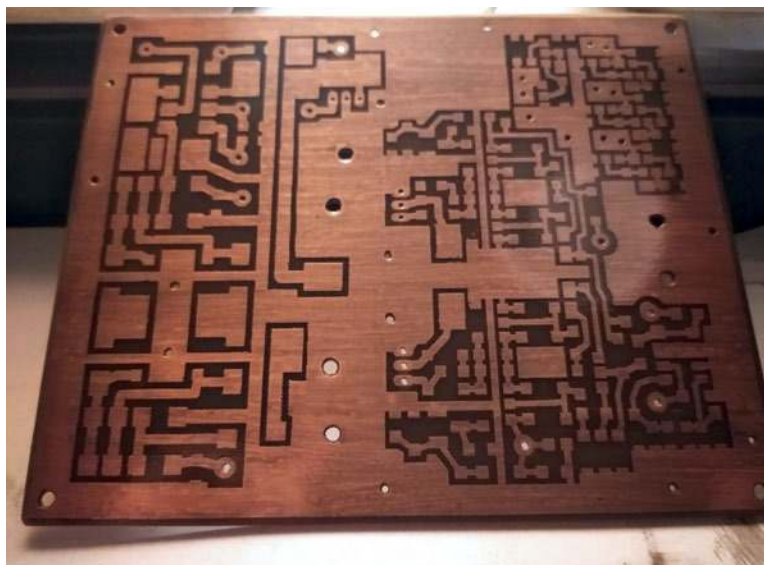
PCB wykonane metodą transferu
