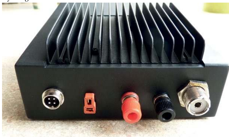
Widok tylnej ścianki obudowy, gniazdo mikrofonowe, gniazdo głośnikowe, dwa zaciski zasilania, gniazdo antenowe
