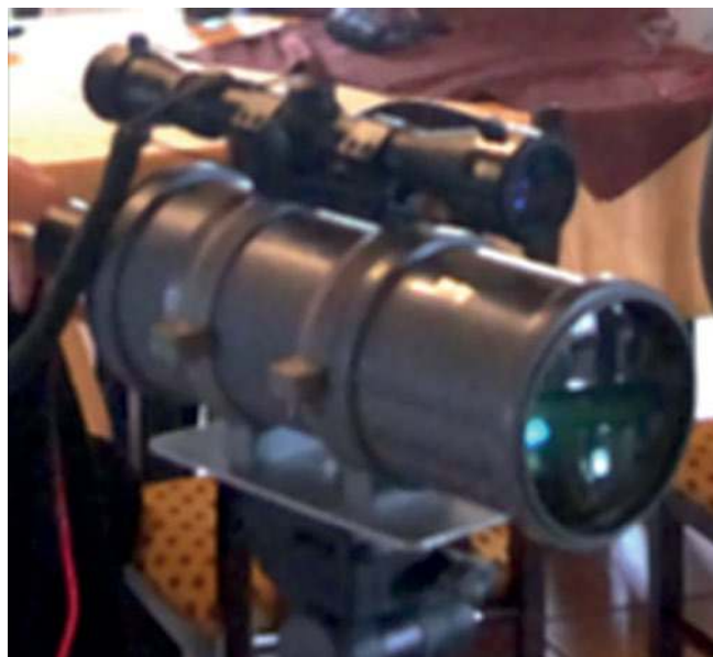
Widok nadajnika do łączności z użyciem światła. Widoczna potężna soczewka skupiająca światło nadawczej diody LED (ta sama soczewka „łapie” promień nadajnika korespondenta)
