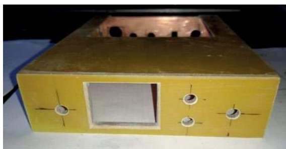
Sposób wykonania obudowy z laminatu
