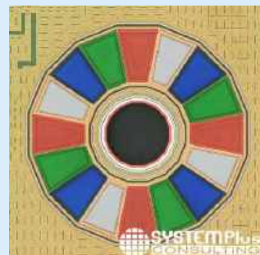
Fotografia 5. Budowa filtra układu TCS3400 [7]
