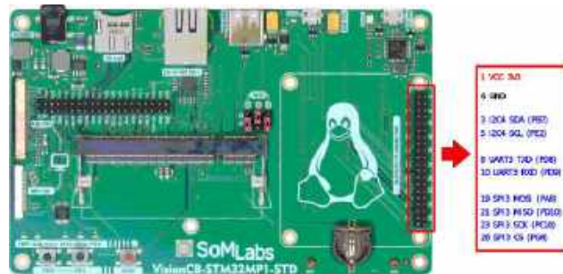
Rysunek 8. Sposób podłączenia modułów peryferyjnych do złącza Raspberry Pi płytki VisionCB-STM32MP1-STD
