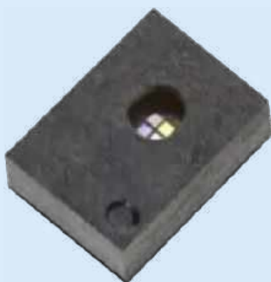
Fotografia 2. Cyfrowy czujnik XYZ z interfejsem I 2 C z pomiarem światła otoczenia (ALS) i podczerwieni (IR) typu TCS3430
