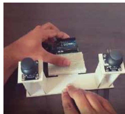
Fotografia 2. Zmontowany kontroler z manipulatorami i elektroniką sterującą
