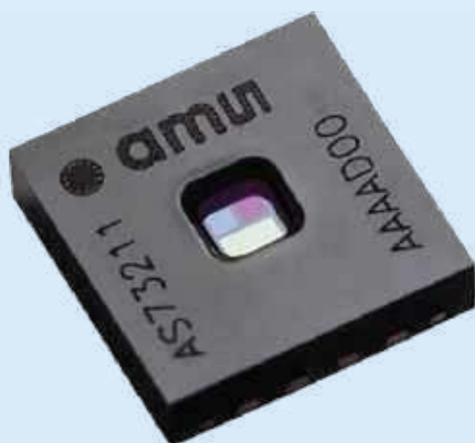
Fotografia 1. Sensor firmy AMS typu AS73211 – JENCOLOR XYZ True Color
