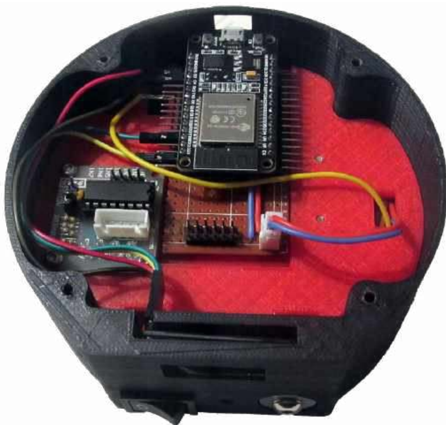
Fotografia 2. Montaż bazy układu wraz z modułami elektronicznymi
