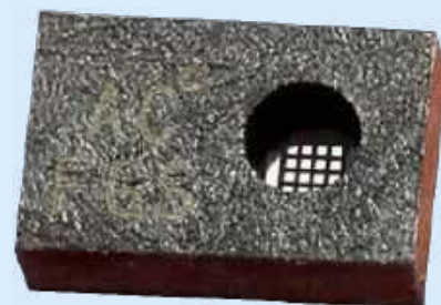
Fotografia 3. Czujnik typu AS7341 – 11-kanałowy sensor wielospektralny
