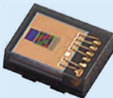
Fotografia 6. Układ APDS-9251 – 20-bitowy sensor RGBIR z interfejsem I²C [9]
