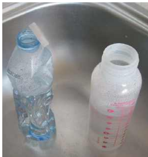
6. Butelka z PET (po lewej) nie wytrzymała wiania wrzątku w przeciwieństwie do butelki dla niemowląt wykonanej z duroplastu (po prawej)
