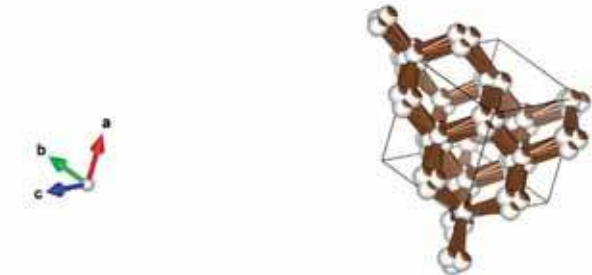
Rys. 2. Struktura syntetycznego kryształu diamentu.
