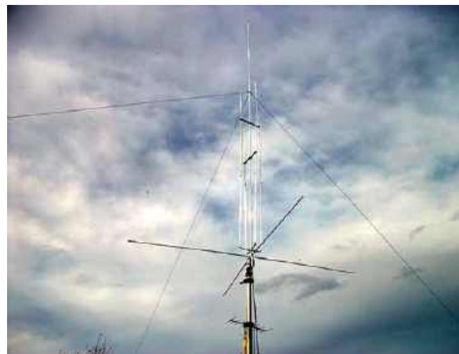
Antena LZAV-5 konstrukcji LZ1GY
