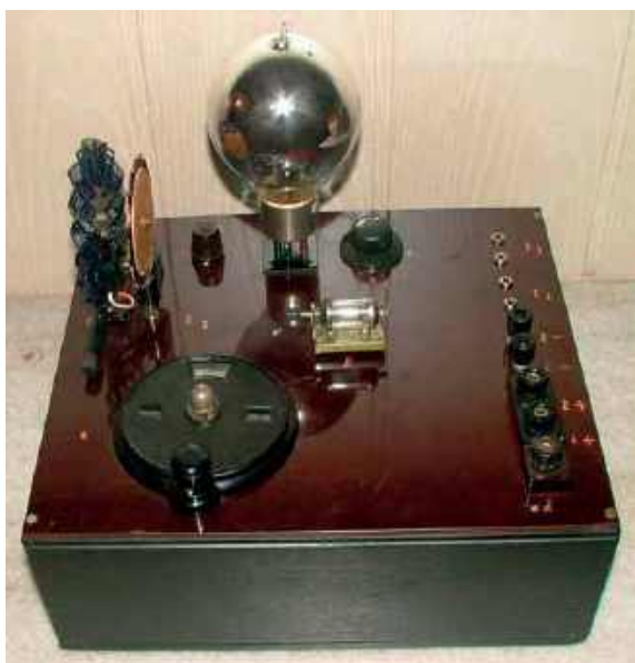
Odbiornik retro na fale długie, skonstruowany na tródmie wykonanej przez Aleksandra Zawadę (stacje z Czech oraz Warszawy bardzo dobrze były słyszalne na słuchawkach)
