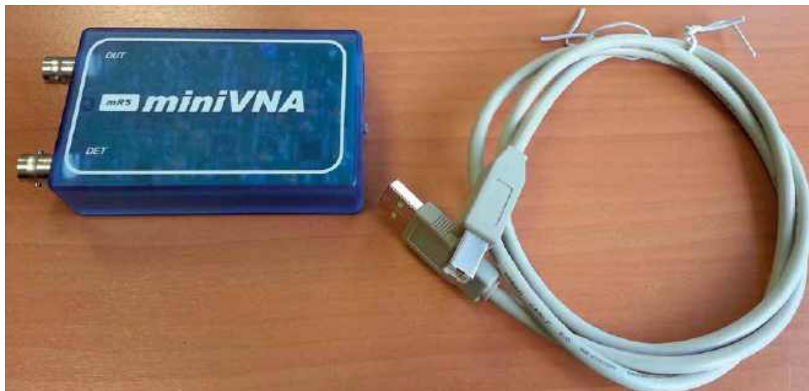
Rys. 8. Analizator anten miniVNA
