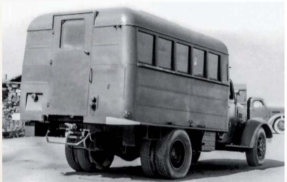
▲ Podstawowy typ nadwozia powstającego w JZS nazywał się N 103. W tym przypadku nadwozie osadzone jest na samochodzie ZIS 150.
