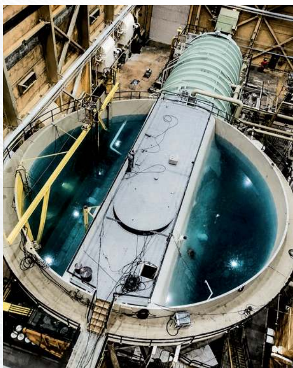
▲ Lądowy prototyp reaktora S1W – stanowisko badawcze programu Nautilus . To na tym obiekcie opracowano i zweryfikowano pierwszą amerykańską siłownię jądrową przeznaczoną dla okrętów podwodnych.
