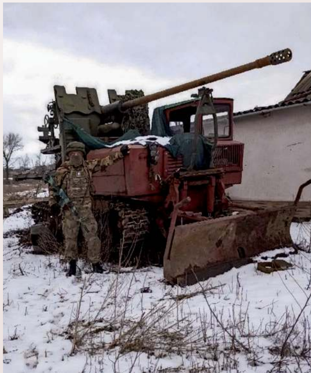
▲ Prawdziwa ekwilibrystyka, ciągnik zrywkowy TDT-55 z armatą S-60. Zdjęcie takiego zestawu opublikowano w marcu 2024 roku.
