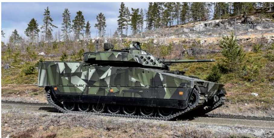
▲ Masa bazowego CV90 kolejnych generacji zwiększyła się z 23–24 ton w pierwszych szwedzkich wozach, do 35–37 ton obecnie, zastosowanie zawieszenia hydropneumatycznego pozwoliło na utrzymanie wymaganych właściwości trakcyjnych.
