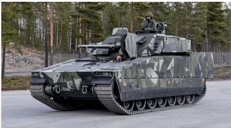
▲ Obecnie produkowany standard CV90 charakteryzuje się m.in. zastosowaniem gąsienic gumowych, które powoli stają się standardem w pojazdach gąsienicowych nowych generacji.
