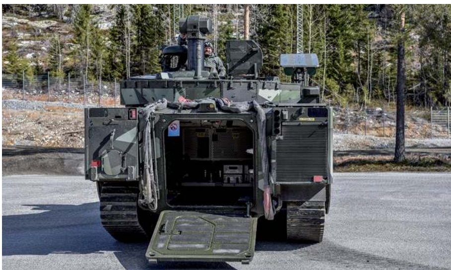
▲ Widok z tyłu na egzemplarz testowy CV90 z otwartą rampą przedziału desantowego.
