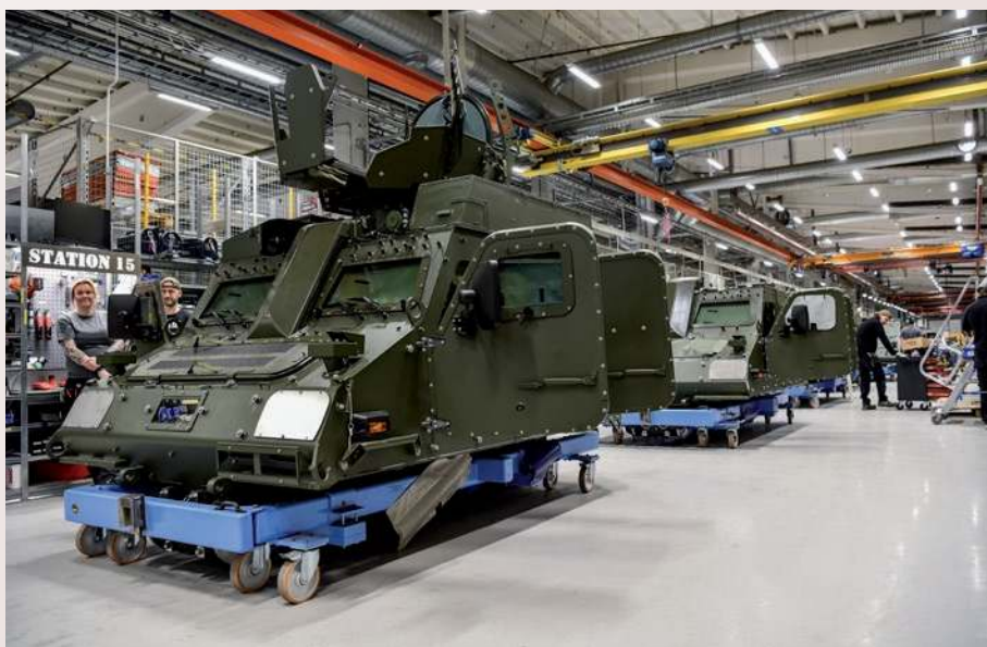
▲ Wytwarzanie BvS 10 w zakładzie w Örnsköldsvik. Zdolności produkcyjne dwuczłonowych pojazdów sięgają 200 sztuk rocznie, ale mają być zwiększane w związku ze sporymi nowymi zamówieniami.
