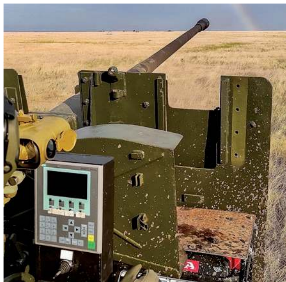
▲ Ukraińskie działo S-60 wyposażone dodatkowo w celownik optoelektroniczny i blok sterowania (lato 2022 r.).
