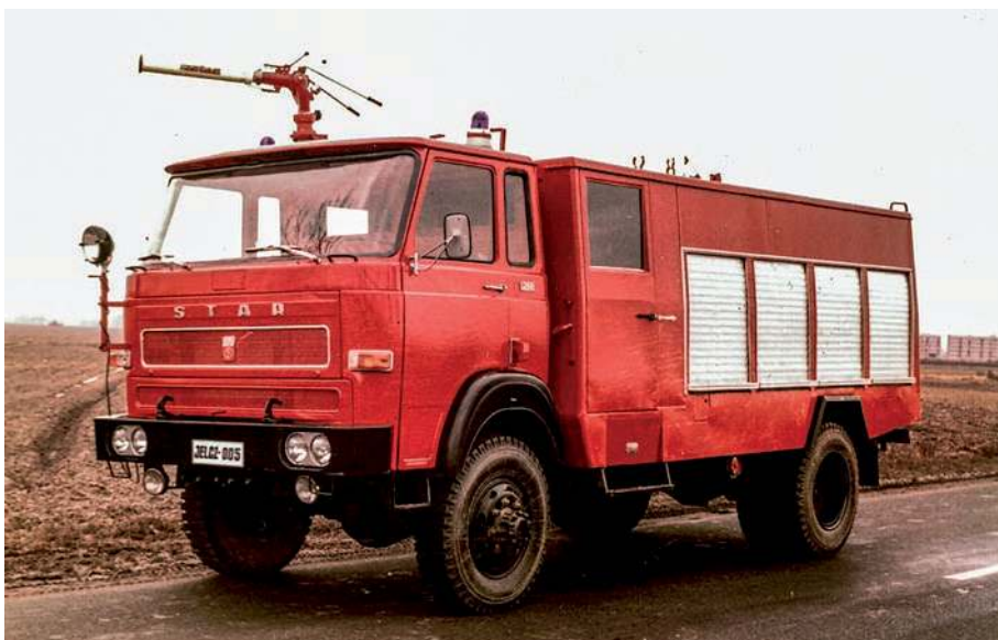
▲ Uterenowiony Star 244L, ale dzięki zabudowie specjalistycznej dokonanej w JZS znany jako samochód pożarniczy Jelcz 005.
