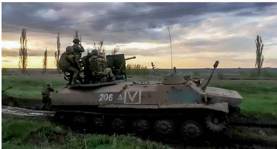
▲ Na rosyjskim podwoziu MT-LB osadzono armatę S-60 (2023 r.). Działo bez dolnej podstawy, z kolei transporter zachował wieżyczkę z karabinem maszynowym.
