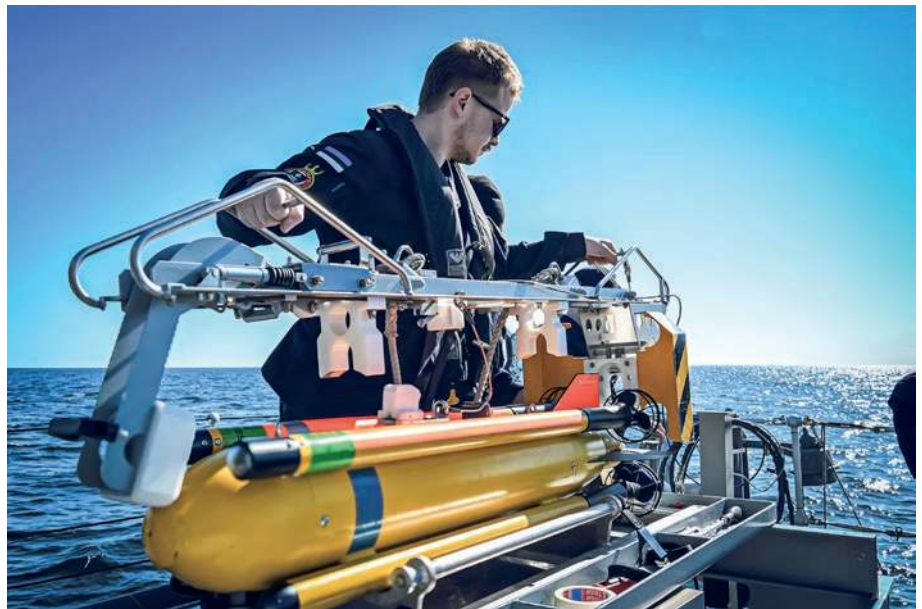
▲ Przygotowanie autonomicznego pojazdu podwodnego (UUV) do realizacji zadania w ramach MCM. Systemy bezzałogowe coraz częściej wspierają działania przeciwwminowe, rozpoznawcze i związane z ochroną infrastruktury krytycznej na dnie Morza Bałtyckiego.
