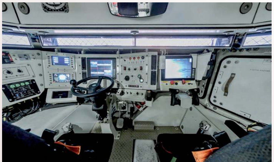
▲ Przednia część kadłuba i widok m.in. na stanowisko kierowcy. FNSS zachwala, że załoganci zajmujący miejsca z przodu wozu mają doskonały widok sięgający blisko 180°.
