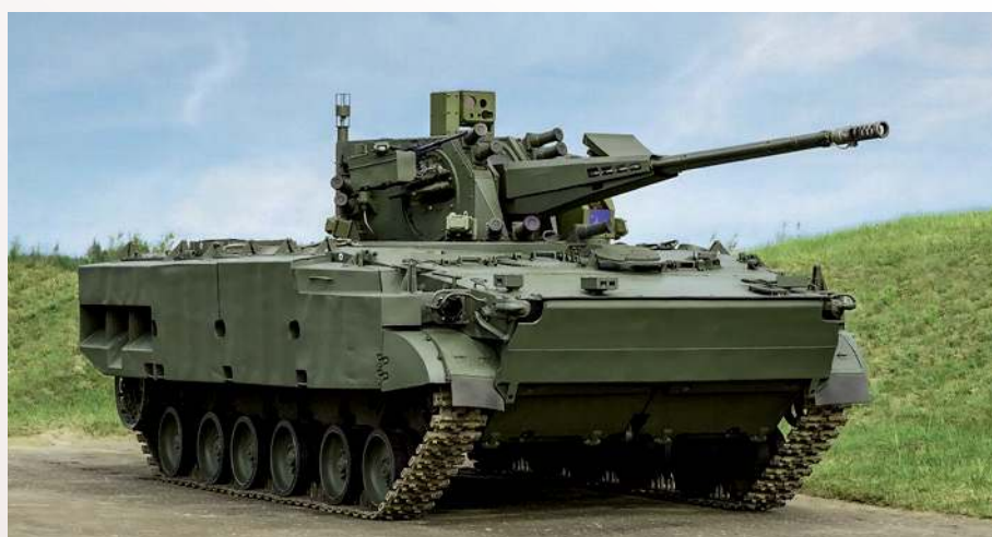
▲ Rosyjskie, kompleksowe podejście do wykorzystania działa znanego z AZP-57, czyli prototyp samobieżnego systemu 2S38 Dieriwacija-PWO .
