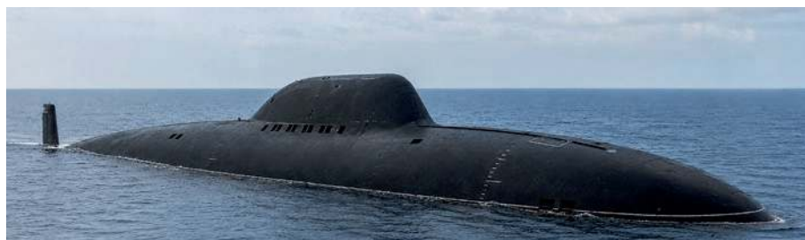
▲ Radziecki okręt projektu 705 Lira (NATO: Alfa) – jedna z najbardziej zaawansowanych konstrukcji czasów tzw. zimnej wojny, wykorzystująca reaktor chłodzony ciekłym metalem zamiast klasycznego PWR.
