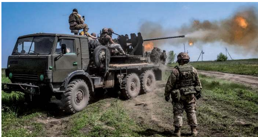
▲ Gun truck z ukraińskiej 28. Samodzielnej Brygady Zmechanizowanej, gdzie działo S-60 posadowiono na podwoziu ciężarówki KamAZ (maj 2023 r.).
