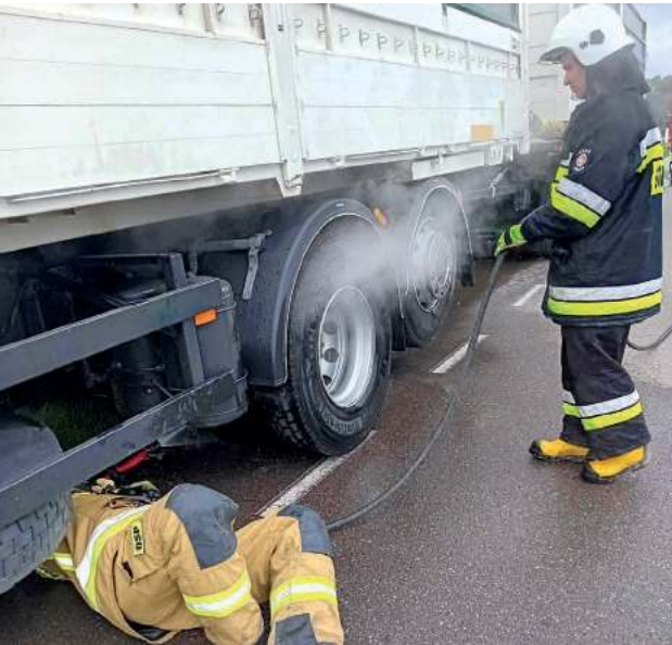
We wtorek 1 sierpnia o godz. 14.27 strażacy otrzymali zgłoszenie o dymie wydobywającym się z ciężarówki na ul. Batalionów Chłopskich w Adamowie. Okazało się, że w samochodzie doszło do awarii układu hamulcowego, stąd doszło do nagrzania bębna koła. Strażacy sprawdzili temperaturę układu hamulcowego kamerą termowizyjną i schodzili go, podając wodę. Na miejscu działały OSP KSRG Adamów, JRG Łuków, Policja. (fot. OSP KSRG Adamów)
