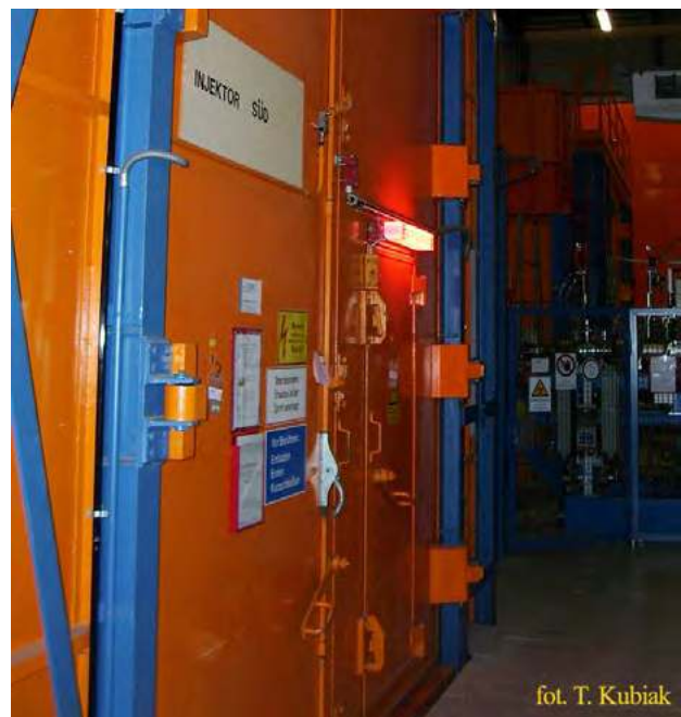
Fot. 2. Charakterystyczne pomarańczowe kontenery mieszczące źródła jonów w GSI.
