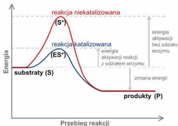
Ryc. 11. Schemat działania enzymu poprzez obniżenie energii aktywacji [7]
