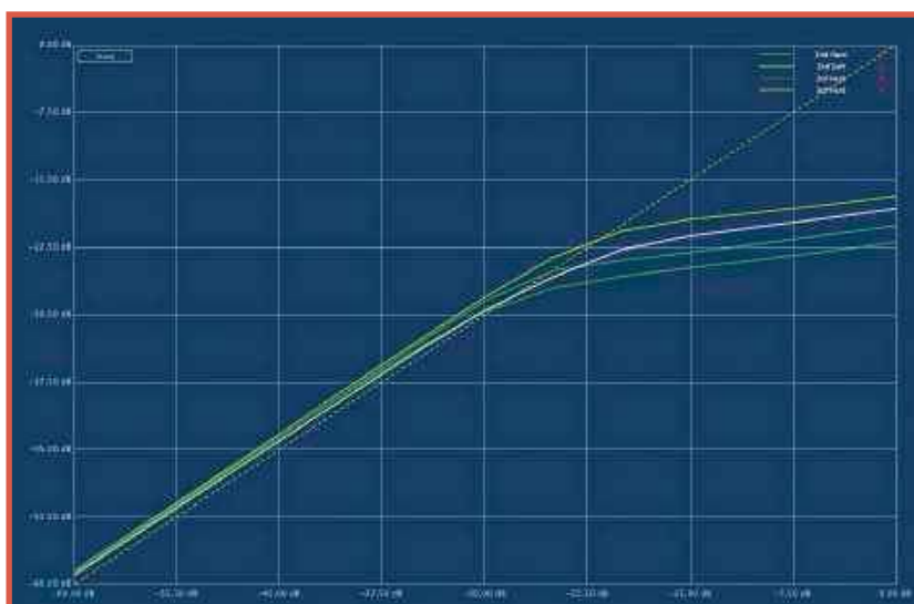
Nie powinno dziwić to, że oba moduły generowania harmonicznych pracują też jako kompresory o różnym progu zadziałania i kolanie charakterystyki, zależnym od trybu pracy (Hard/Soft) i głębokości nasycenia (Drive).
