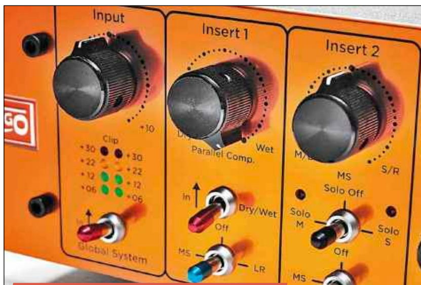
Dla pierwszego insertu przewidziano funkcję przetwarzania równoległego, a dla drugiego pracę szeregową. W obu przypadkach można użyć trybu stereo lub Mid-Side.
