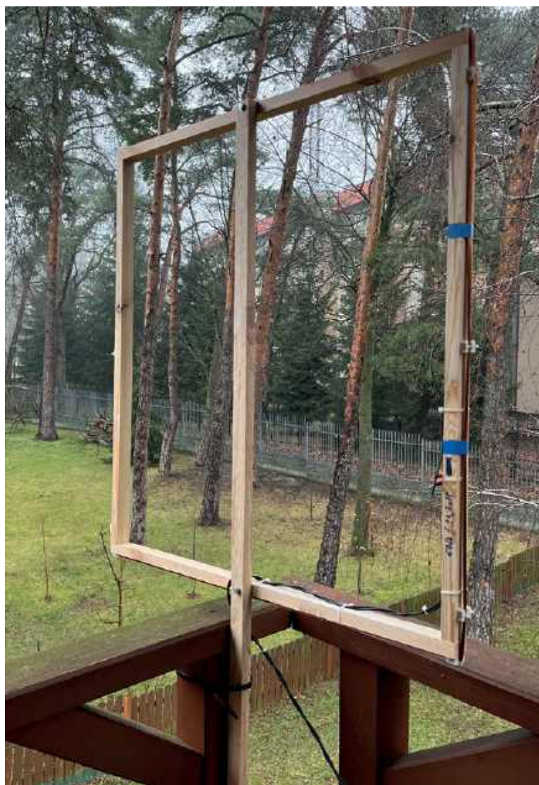
Fot. 1. Konstrukcja mechaniczna anteny pętlowej
