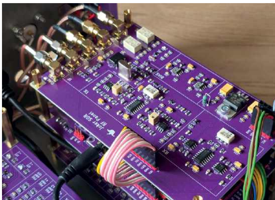
Widok zmontowanego toru pośredniej częstotliwości układu hybrydowego
