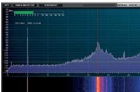
Fot. 6. Widmo sygnału na wyjściu przedwzmacniacza z odłączoną anteną
