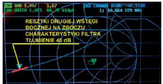
Rys 10. Miejsce resztek niepożądej wstęgi bocznej wytłumionej w modulatorze na zboczach filtra (dodatkowe tłumienie 40dB)
