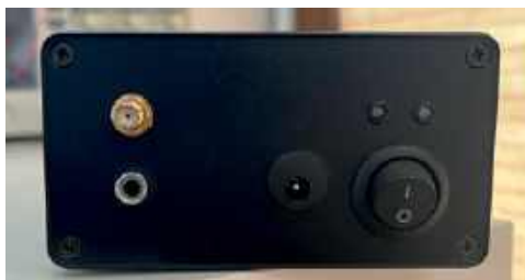
Fot. 5. Konstrukcja mechaniczna układu przedwzmacniacza
