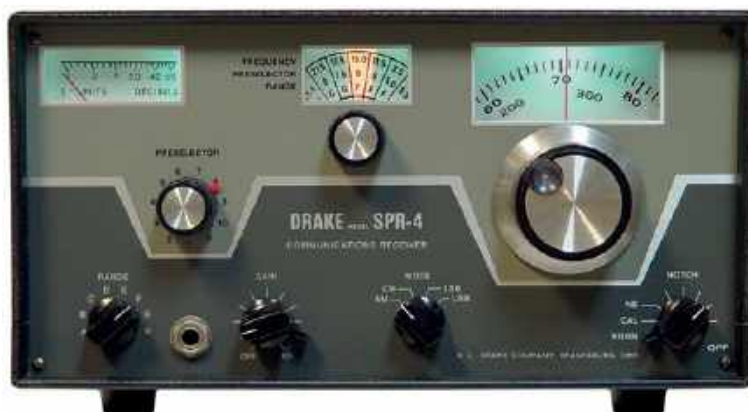
Odbiornik tranzystorowy AM/SSB/CW Drake SP R4 przed modernizacją (zakres częstotliwości: 0,15–30 MHz, wymiary: 274 × 140 × 324 mm, waga: 8,2 kg)
