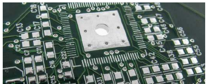
Fotografia 4. Płytką z pokryciem padów metodą LF HASL
