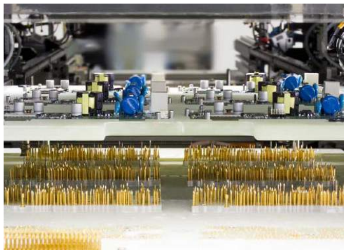
Fotografia 12. Urządzenie do testowania połączeń – Bed of Nails
