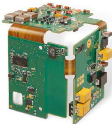
Fotografia 1. Przykład gotowego obwodu wykonanego na płytce PCB sztywno-giętkiej (rigid-flex)
