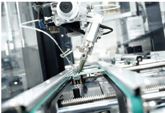
Fotografia 8. Robot lutowniczy w trakcie pracy
