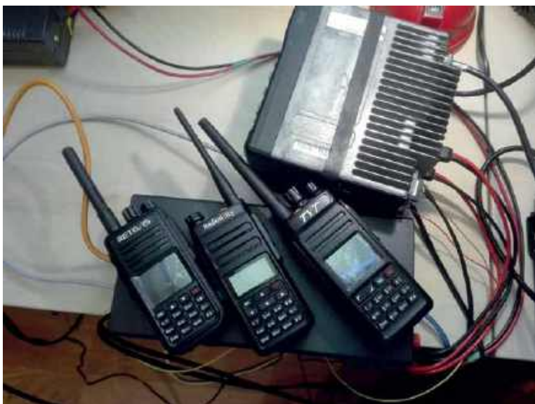
Przeмиennik w trakcie montażu w Polsce, zestaw radiotelefonów do przekazania
