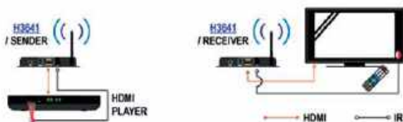
Schemat podłączenia telewizora do źródła sygnału HDMI za pomocą bezprzewodowego konwertera Wi-Fi H3641
