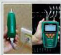
test kabli LAN, telefonicznych i koncentrycznych
