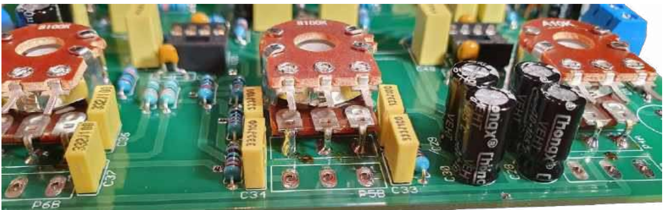
Fotografia 3. Przyłutowane „dolne” wyprowadzenia
