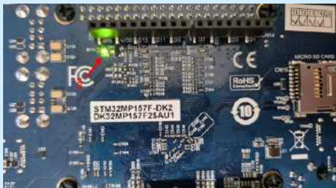
Fotografia 1. Widok płytki ewaluacyjnej z włączoną diodą LED LD9
