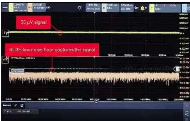
Rysunek 6. „Namierzenie” sygnału na poziomie 53 µV za pomocą funkcji FFT w oscyloskopie HD3 marki Keysight ( https://t.ly/E0NgG )
