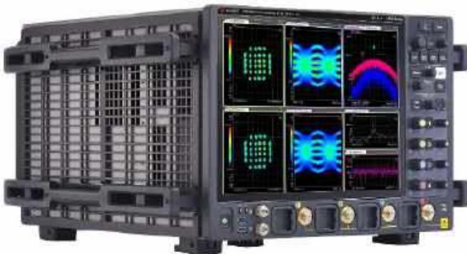
Fotografia 1. 4-kanałowy, 110-gigahercowy oscyloskop z serii UXR marki Keysight ( https://t.ly/MdC0l )
