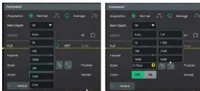
Rysunek 3. Widok menu wyboru rozmiaru pamięci w oscyloskopie z serii DHO800 przed i po odblokowaniu płatnych opcji ( https://t.ly/cC-aQ )
