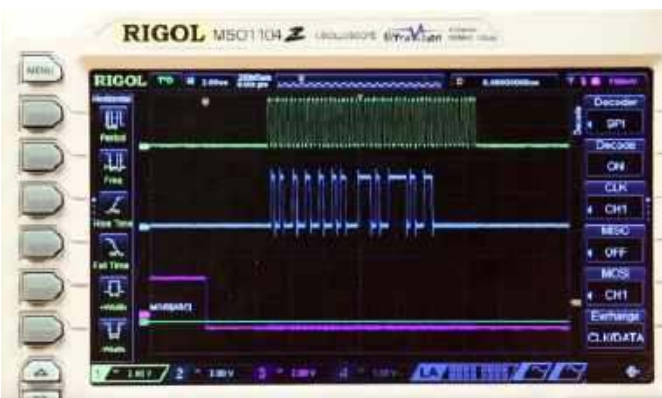
Fotografia 3. Dekodowanie danych na szynie SPI na podstawie odczytu z kanałów analogowych ( https://t.ly/5VgNv )
