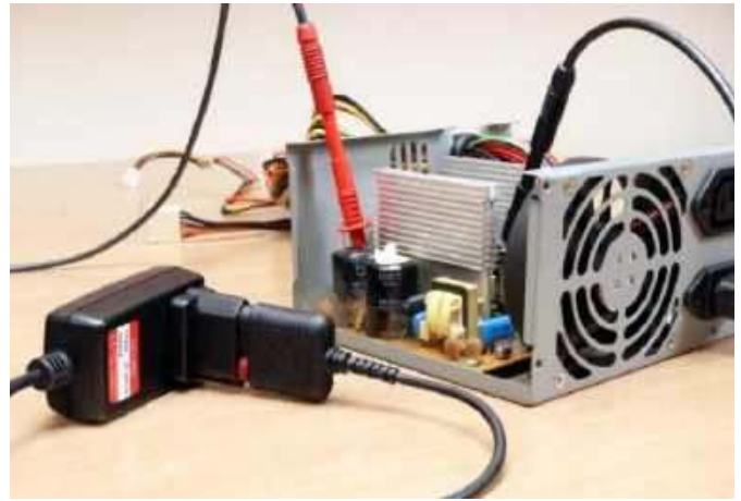
Fotografia 4. Zastosowanie analizatora Handyscope TP450 do pomiarów zasilacza ATX
