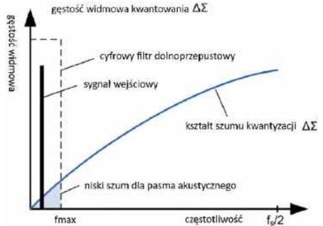
Rysunek 18. Kształtowanie szumu kwantyzacji \Delta\Sigma
