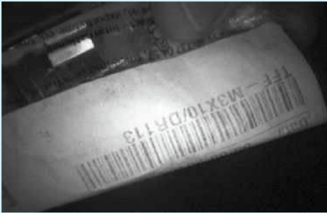
Fotografia 7. Test odczytu uszkodzonego kodu 1D o niskim kontraście
