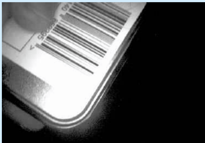
Fotografia 5. Kod kreskowy na opakowaniu – test akwizycji obrazu szybko przesuwającego się obiektu
