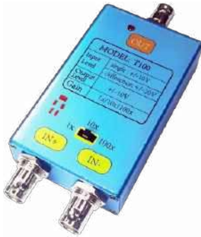
Fotografia 2. Tani przedwzmacniacz różnicowy do oscyloskopów produkcji chińskiej z AliExpress ( https://tiny.pl/x66sxtnt )
