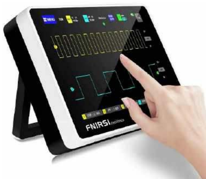
Fotografia 21. Oscyloskop „w pełni dotykowy” – model 1013D marki Fnrirsi ( https://t.ly/uMbHZ )
