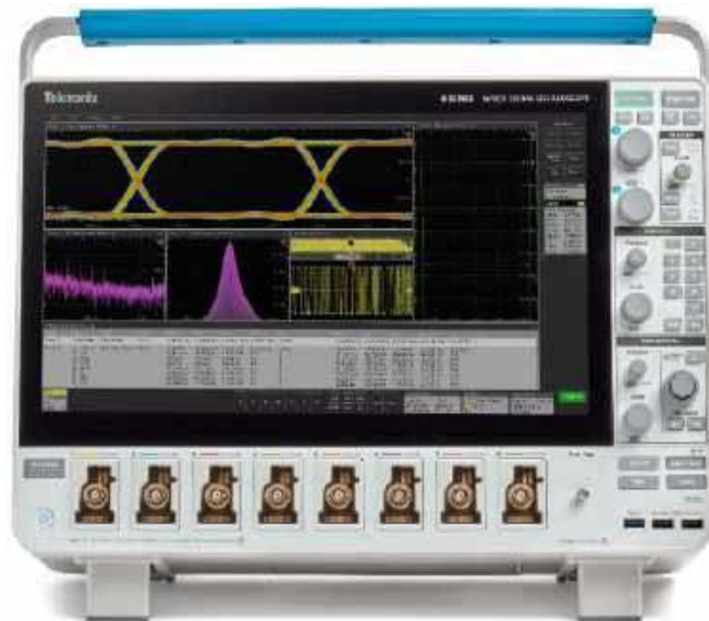
Fotografia 8. Oscyloskop z rodziny 6 Series B MSO marki Tektronix ( https://t.ly/w50nz )
