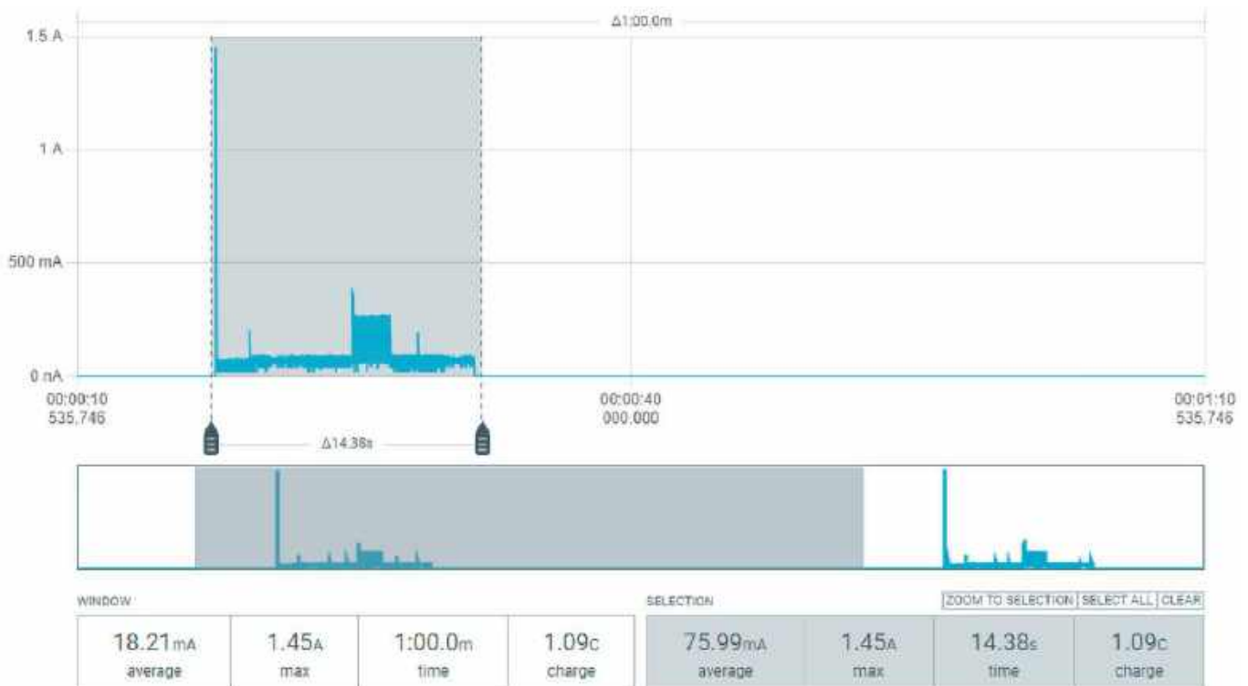
Rysunek 1. Pobór prądu z baterii, dwa bloki pomiarowe
