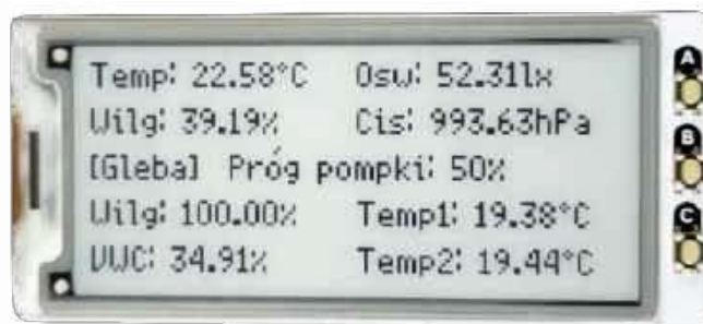
Fotografia 1. Przykład pomiaru z czujnikami wilgotności umieszczonymi w wodzie
