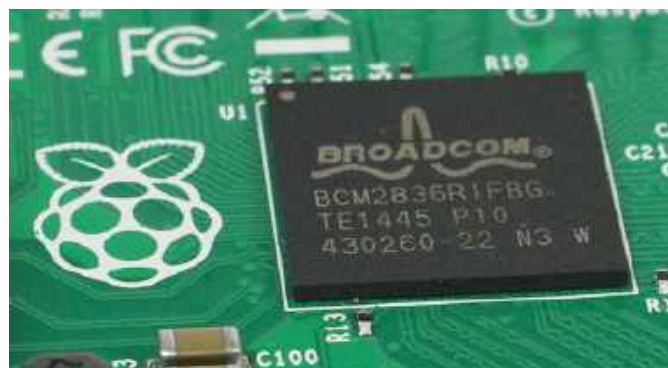
Fotografia 3. Układy Broadcom BCM2835/BCM2836 bazują na architekturze ARMv6 i są stosowane na płytkach Raspberry Pi 1 oraz 2 ( https://t.ly/Nbk50 )
