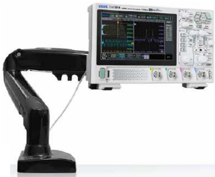
Fotografia 19. Oscyloskop z serii DHO800 marki Rigol zamontowany na wysięgniku przeznaczonym do monitorów komputerowych ( https://t.ly/KA9sf )
