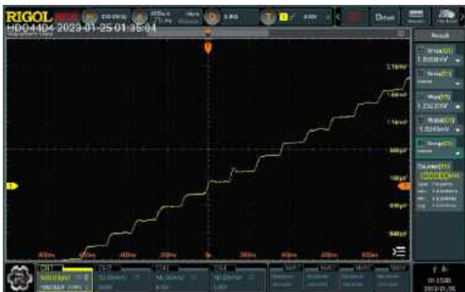
Rysunek 5. Uśrednienie danych pozwala znacznie wygładzić niepożądany szum i jeszcze lepiej uwidocznić istotne cechy sygnału ( https://t.ly/YzONZ )
