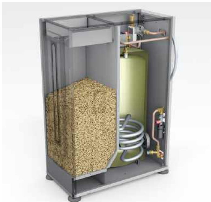
Kocioł na pelety wyposażony jest m.in. w zaizolowany zasobnik do produkcji c.w.u. ze stali nierdzewnej, wbudowany zbiornik buforowy, pompę obiegową c.o., naczynia wzbiorcze do c.o. i c.w.u., odpowietrzniki i zawory bezpieczeństwa. MORA
