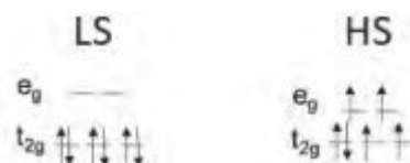
Rys. 5. Skrócone konfiguracje elektronowe jonu metalu o sześciu elektronach walencyjnych w niskim i wysokim stanie spinowym [1]
