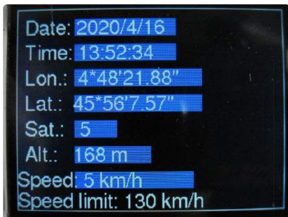
Rysunek 3. Dane GPS są dostępne na tym ekranie. Jest to również ekran zapewniający dostęp do definicji ograniczeń prędkości
