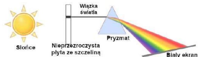
Najprostszym spektroskopem jest szklany pryzmat (Wikimedia Commons, edytowane przez Jos Verstraten)
