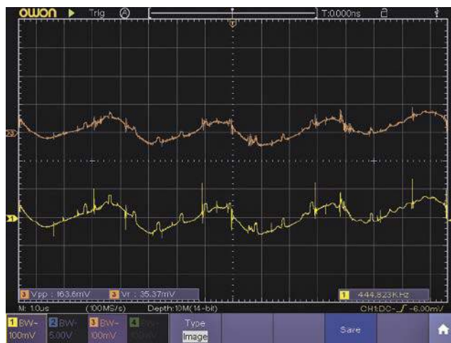
Oscylogram 2. Przy pełnym obciążeniu 5 A, tętnienia o częstotliwości przełączania 260 kHz są bardziej wyraźne, ale nadal mniejsze niż 100 mV międzyszczytowe (pomarańczowy przebieg). Żółty przebieg pokazuje napięcie przed wyjściową cewką toroidalną, aby uwidocznić skuteczność w redukcji szumów nawet przez kilku zwojów dławika
