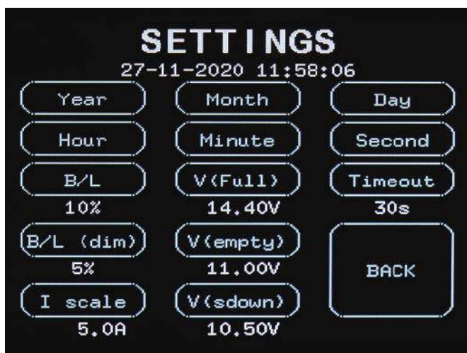
Ekran 3. Ekran ustawień zawiera najczęściej używane opcje konfiguracji rejestratora, w tym napięcia baterii, godzinę i datę oraz sterowanie podświetleniem. Każdy wpis jest sprawdzany, aby upewnić się, że nie koliduje z innymi wartościami (takimi jak napięcie „Rozładowany” jest wyższe niż napięcie „W pełni naładowany”), a następnie natychmiast zapisywany w pamięci FLASH
