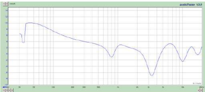
Rysunek 7. Przykładowa charakterystyka amplitudowo-częstotliwościowa sumy kanałów wysokotonowego oraz nisko-średniotonowego badanego aktywnego monitora studyjnego zmierzona przy pomocy programu komputerowego audioTester
