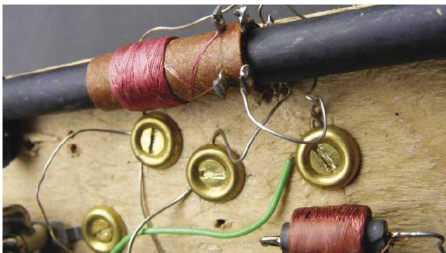
Rysunek 32. Długofalowa cewka antenowa; zauważ jak dwa oddzielne uzwojenia są połączone pod spodem, żeby uzyskać odczep
