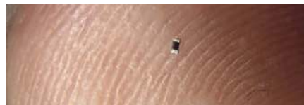
Ten element o rozmiarze SMD 0201, pokazany na czubku palca, mierzy zaledwie 0,6×0,3 mm, co sprawia, że łatwo go zgubić
