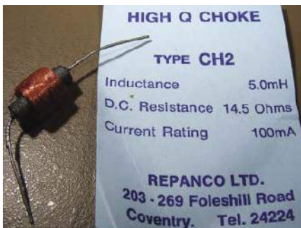
Rysunek 30. Repanco CH2 RFC. Ten wykorzystuje nawinięcie koszykowe i licę, aby zminimalizować straty
