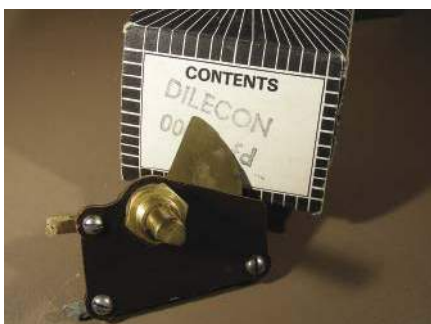
Rysunek 27. Oryginalny kondensator strojeniowy Jackson Dilecon
