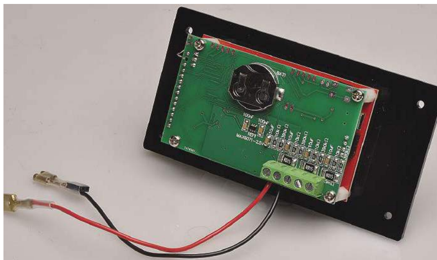
Po zamontowaniu wewnątrz obudowy urządzenia, ważne funkcje są dostępne dla konserwacji, w tym zakończenia kabli i bateria zapasowa RTC
