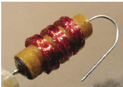
Rysunek 29. Mouser sprzedaje odpowiedni dławik. Ten jest produkcji Bournsa. Zwróć uwagę na wiele warstw uzwojenia dla redukcji pojemności pasożytniczych
