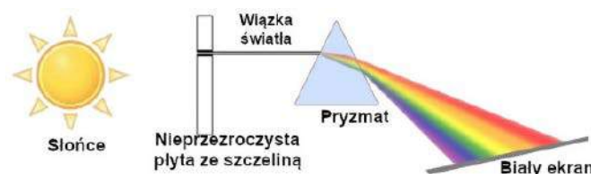
Najprostszym spektroskopem jest szklany pryzmat (Wikimedia Commons, edytowane przez Jos Verstraten)
