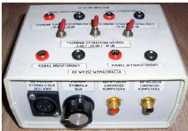
Rysunek 5. Wygląd zewnętrzny gotowej przystawki do systemu pomiarowego wykorzystującego program komputerowy audioTester
