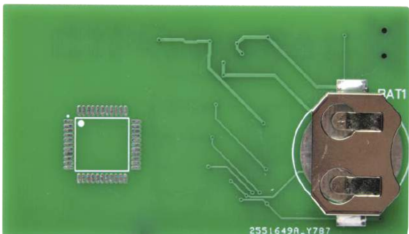
Na spodzie płytki drukowanej znajduje się zestaw styków TQFP. Służą on do ćwiczenia lutowania i nie ma żadnego połączenia elektrycznego z obwodem
