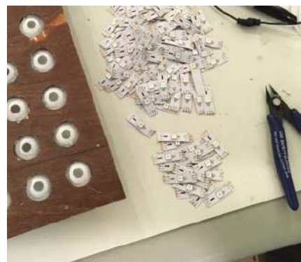
Rysunek 3. Cięcie segmentów NeoPixel
