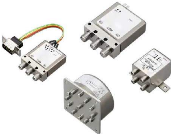
Fotografia 10. Mikrofalowe moduły przełącznikowe z serii ARD marki Panasonic ( https://t.ly/7Yor )
