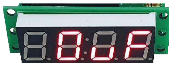
Fotografia 3. Sposób sygnalizacji przepiętnienia licznika
