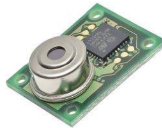
Fotografia 4. Moduł pirometru wielostrefowego D6T-32L-01A marki Omron ( https://t.ly/vdiXS )
