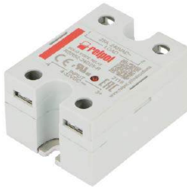
Fotografia 4. Przełącznik półprzewodnikowy typu RSR52-24D25-R. Podstawa modułu została wykonana z metalu pomagającego odprowadzać ciepło
