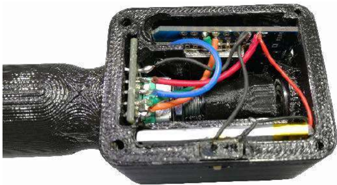
Fotografia 6. Wszystkie zlutowane elementy elektroniczne umieszczone w uchwycie głównym
