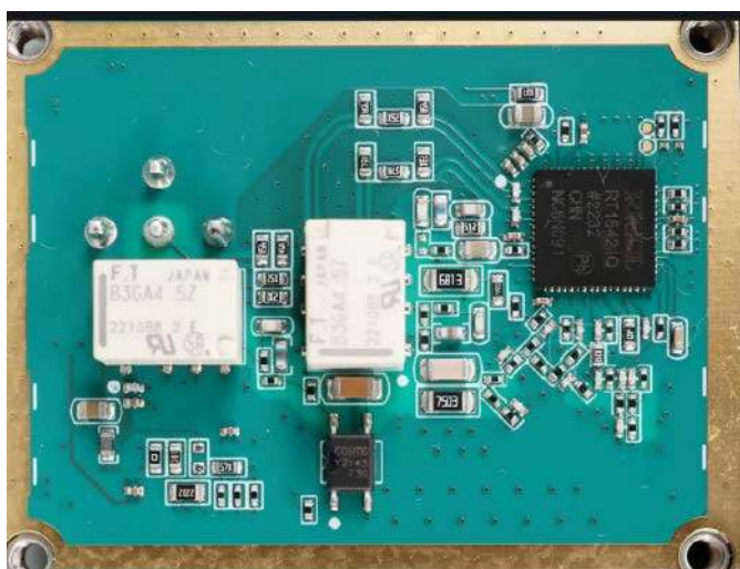
Fotografia 3. Przekaźniki sygnałowe FTR-B3 GA4.5Z (Fujitsu), zastosowane we front-endach kanałów wejściowych oscyloskopów z serii DHO4000 marki Rigol ( https://t.ly/mE21F )
