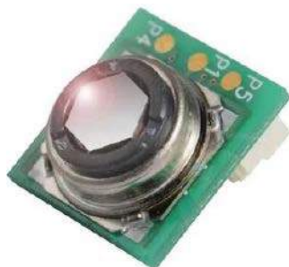
Fotografia 3. Czujnik temperatury z serii D6T marki Omron ( https://t.ly/ek0q )
