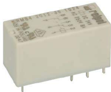
Fotografia 1. Przełącznik RM84 (dwa zestyki) z cewką na napięcie 24 V ( https://bit.ly/3LoN6tn )
