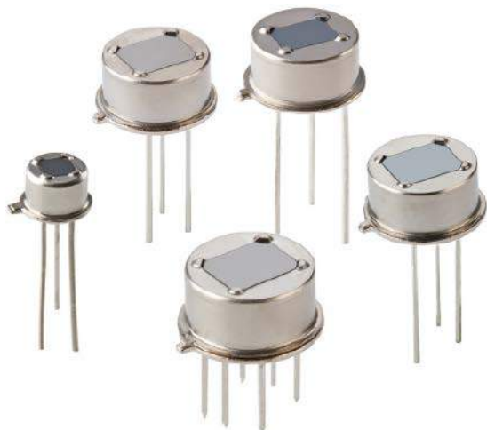
Fotografia 6. Przykładowe czujniki piroelektryczne dwuelementowe z oferty marki ExcelitasTechnologies ( https://t.ly/-NwK )
