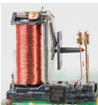
Fotografia 2. Widok prostego przełącznika SPST bez pokrywy ochronnej ( https://t.ly/48mF )
