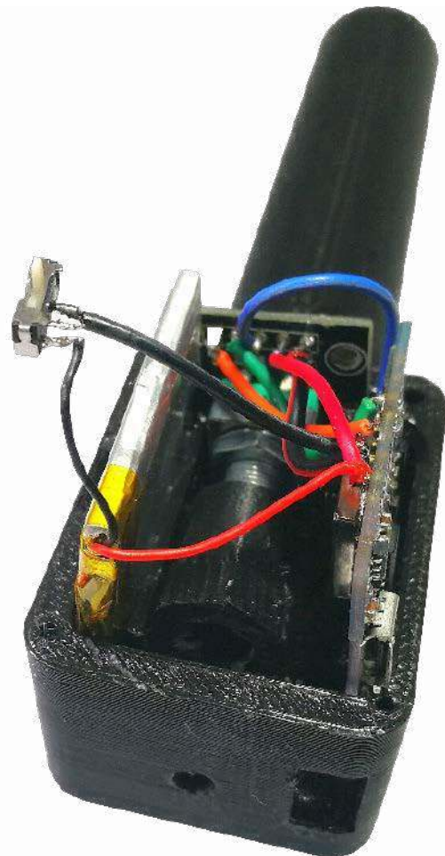
Fotografia 4. Montaż elektroniki w obudowie
