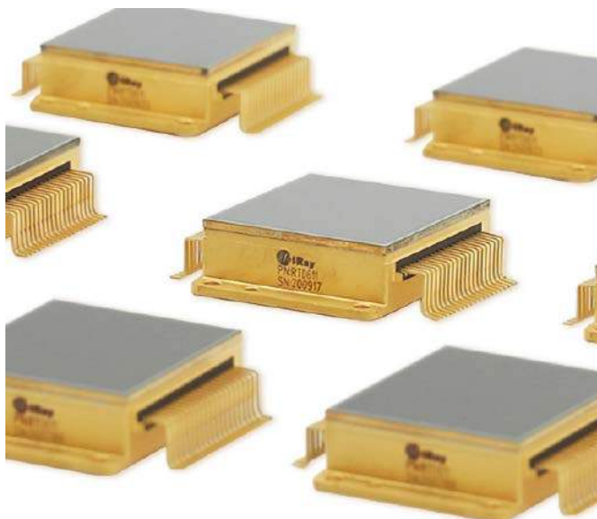
Fotografia 16. Szybkie matryce termowizyjne o rozdzielczości 640×512 px i stałej czasowej 10 ms – RTD6122M marki InfiRay ( https://t.ly/yj1Z )
