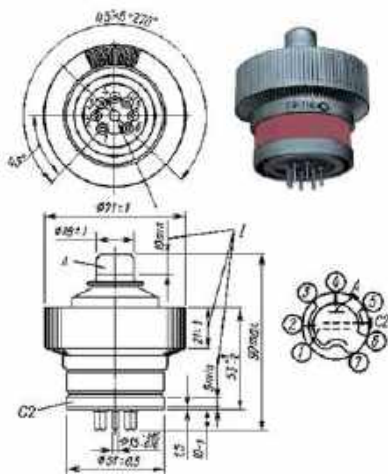
Rys. 1. Konstrukcja i wyprowadzenie cokołu GU-74B
