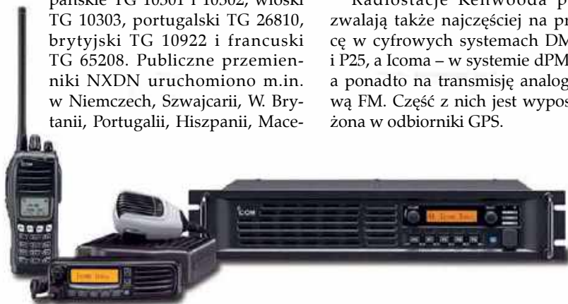
Sprzęt radiowy NXDN firmy Icom. Po prawej stronie widoczny przebiennik
