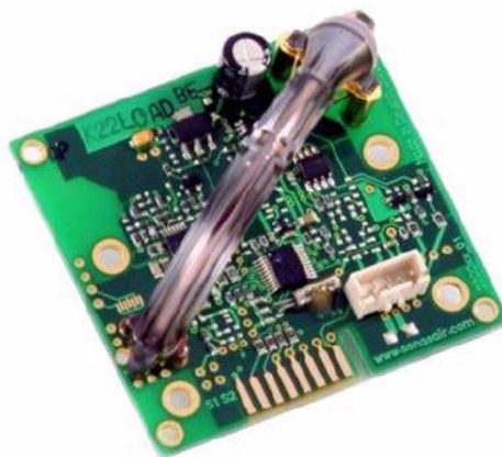
Rysunek 6. Czujnik NDIR z komorą próbną w kształcie banana
