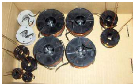
Rysunek 7. Zestaw gotowych cewek powietrznych wykonanych na zaproponowanym urządzeniu
