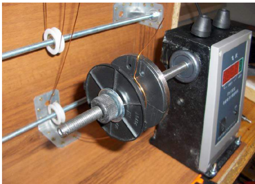
Rysunek 12. Sposób zamocowania karkasu L15 we wrzeciono nawijarki za pośrednictwem tarczy zabierakowej i zakontrowaniu karkasu nakrętką za pośrednictwem podkładki
