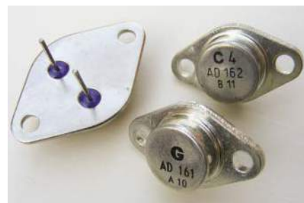
Rysunek 11. Tranzystory wyjściowe Mullard AD161/2 (po prawej). Bardzo popularny typ w latach 70-tych. Robert's użył ich w swoim radiu stolowym RM50 wraz z głośnikiem Celestion. Zwróć uwagę na ich małą obudowę TO66 w porównaniu do standardowej TO3 (po lewej)
