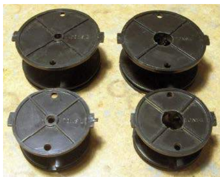
Rysunek 4. Karkasy produkcji firmy Tonsil po rozwierceniu wiertłem o średnicy Ø10 mm [https://www.skleptonsil.pl/korpusey-cewek,c230.html]
