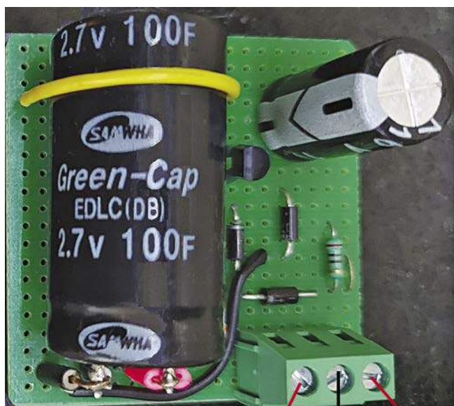
Rysunek 1. Prototyp zasilania zegara z wykorzystaniem solarne panelu FV i superkondensatora
