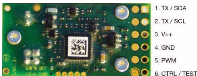
Rysunek 21. Dane dotyczące połączenia czujnika T6713
