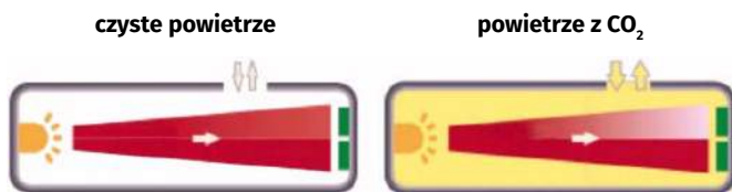
Rysunek 3. Zasada działania czujnika NDIR
