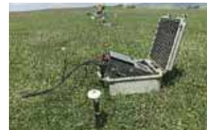
Magnetotelluryczna aparatura pomiarowa podczas rejestracji danych polowych.
