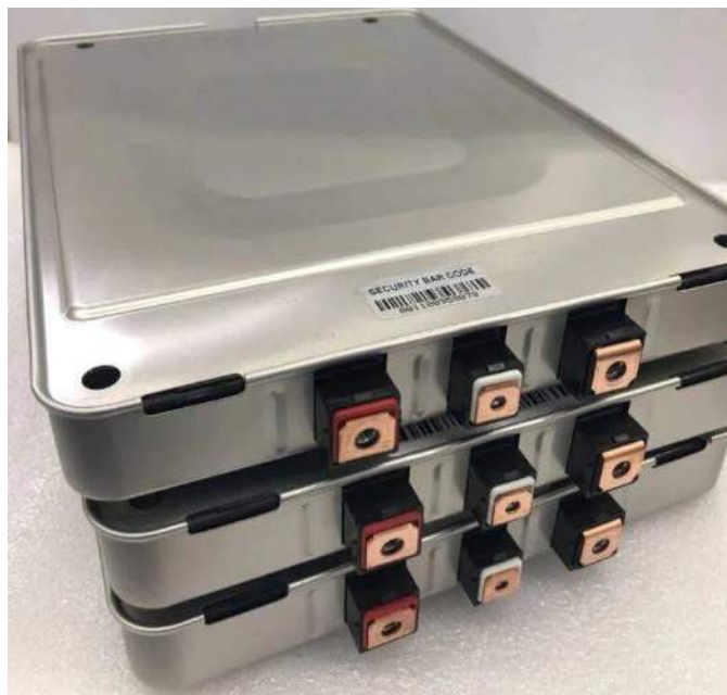
Fotografia 4. Akumulatory LMO stosowane w autach Nissan Leaf
