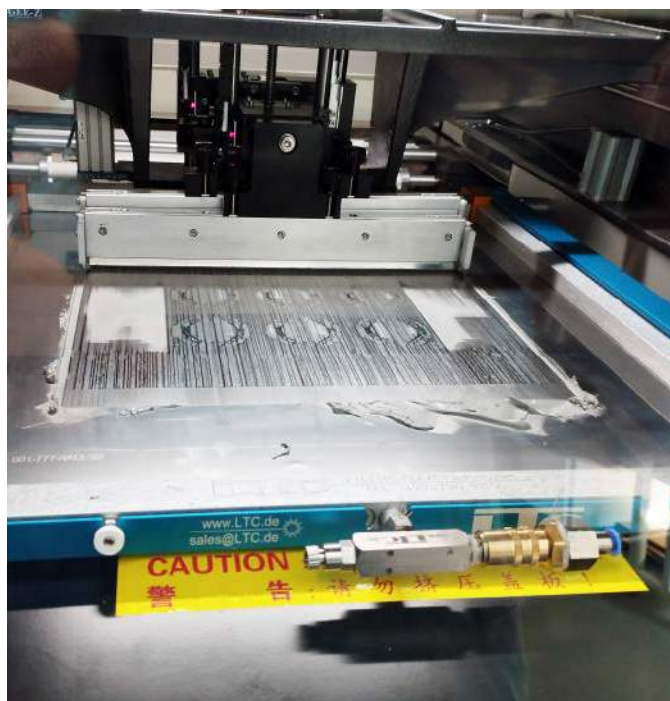
Fotografia 1. Nakładanie pasty lutowniczej w procesie montażu SMT
