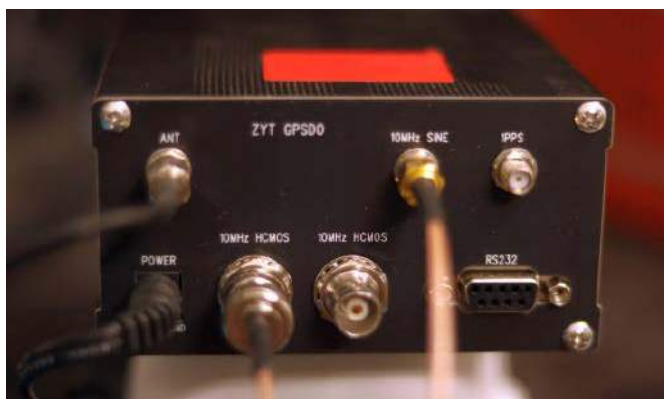
Fotografia 2. Tylny panel urządzenia GPSDO
