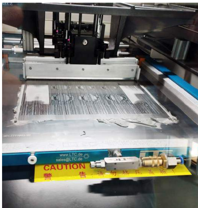
Fotografia 1. Nakładanie pasty lutowniczej w procesie montażu SMT
