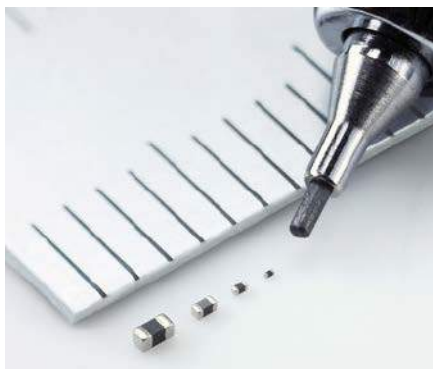
Fotografia 6. Porównanie wielkości komponentów SMD w rozmiarach 0402, 0201, 01005 oraz 008004. Ten ostatni to najmniejszy na świecie dławik ferrytowy, opracowany przez firmę Murata – jego wymiary to zaledwie 0,25×0,125 mm ( https://t.ly/7jRNd )
