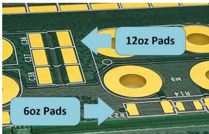
Fotografia 12. PCB w technologii heavy copper ze zróżnicowaną grubością miedzi w różnych obszarach tej samej warstwy ( https://t.ly/8lxxrk )
