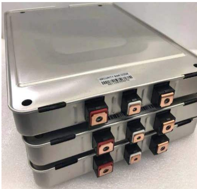
Fotografia 4. Akumulatory LMO stosowane w autach Nissan Leaf
