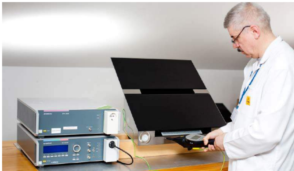
Fotografia 6. Test odporności na wyładowania elektrostatyczne (ESD)
