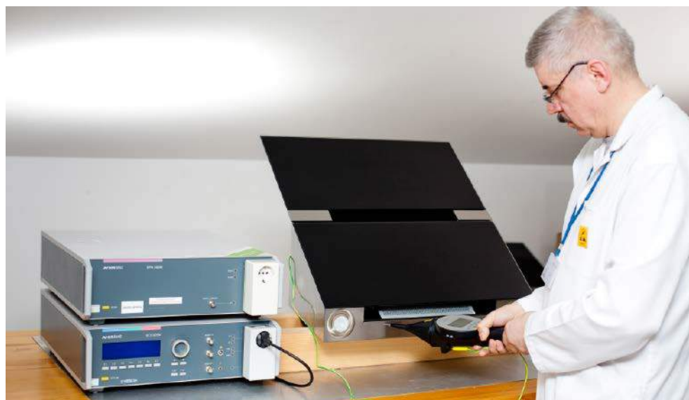
Fotografia 6. Test odporności na wyładowania elektrostatyczne (ESD)
