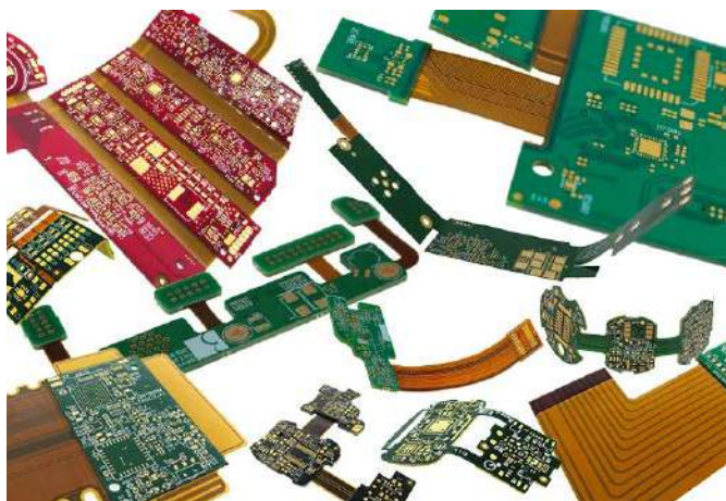
Fotografia 8. Przykładowe obwody typu rigid-flex ( https://t.ly/5Kho3 )
