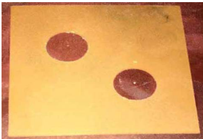
Fotografia 8. Arkusz prepregu, przeznaczony do pomiarów płynięcia żywicy ( https://bit.ly/476fQPK )
