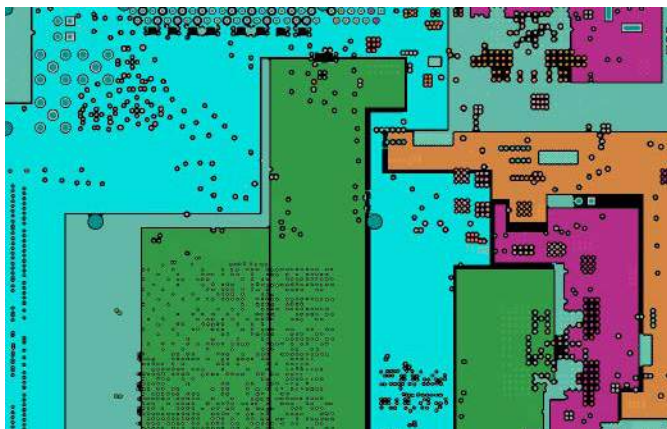
Rysunek 9. Przykład płaszczyzny zasilania, podzielonej na szeregi sekcji o różnym przeznaczeniu (np. zasilanie części analogowej, cyfrowej i RF) oraz różnych poziomach napięcia ( https://t.ly/DnLRY )
