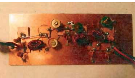
Rys. 3. Schemat filtru pasmowego 7 MHz
