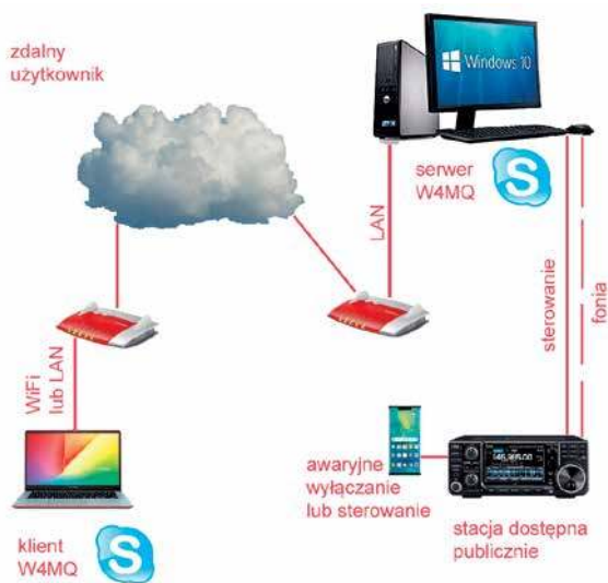
Rys. 1. Schemat blokowy publicznej stacji internetowej z oprogramowaniem W4MQ i Skype'em do transmisji dźwięku
