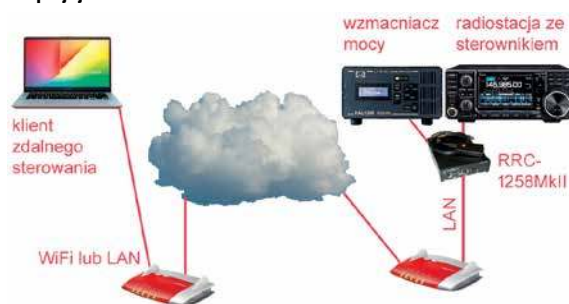
Rys. 4. Sterownik Remoterig współpracuje z wieloma modelami radiostacji i różnymi programami sterującymi. Po stronie zdalnego operatora zamiast komputera można użyć drugiego sterownika i płyty czołowej radiostacji
