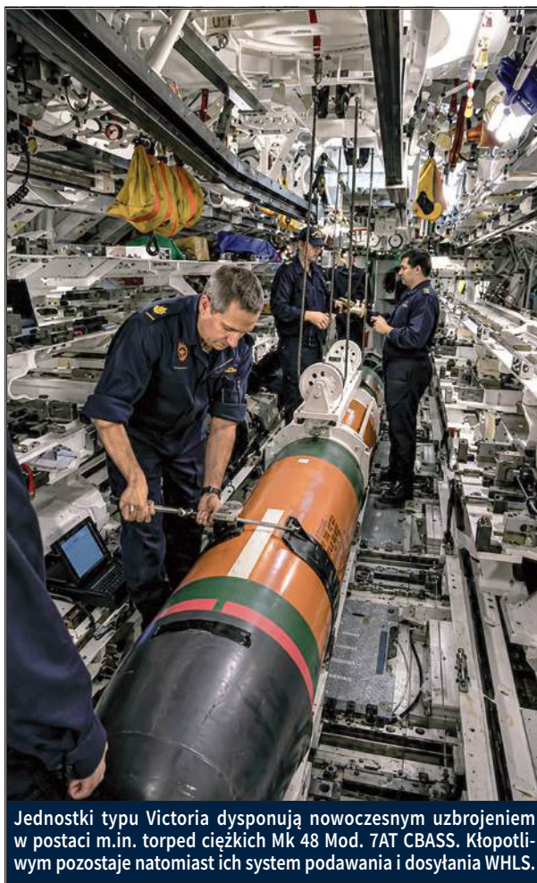
Przedział uzbrojenia z sześcioma wyrzutniami torped kal. 533,4 mm. Okręty dysponują podstawowym zapasem 18 środków bojowych.
