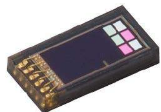
Fotografia 6. Układ TSL2585 marki ams OSRAM ( https://t.ly/OLZxX )
