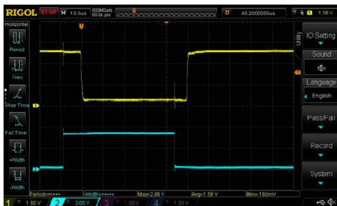
Rysunek 6. Przebieg na wyjściu wzmacniacza transimpedancyjnego (CH1), współpracującego z fototranzystorem ( https://t.ly/Mn2jL )
