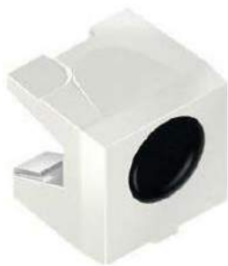
Fotografia 7. Fototranzystor w obudowie SMD do montażu kąto-owego ( https://t.ly/bk5w )
