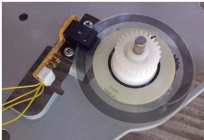
Fotografia 14. Zespół precyzyjnego enkodera inkrementalnego drukarki, złożony z modułu transceptora szczelinowego oraz tworzywowej tarczy z naniesionymi znacznikami optycznymi ( https://t.ly/CF6v )
