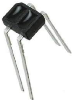
Fotografia 11. Transceptor odbiciowy QRE1113 ( https://t.ly/vmrSQ )
