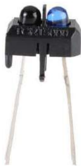
Fotografia 12. Transceptor odbiciowy TCRT5000 ( https://t.ly/8HEG )
