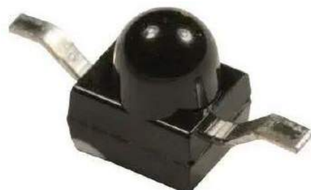
Fotografia 6. Fototranzystor w odwróconej obudowie SMD (do montażu od spodu płytki drukowanej) – https://t.ly/u8NS
