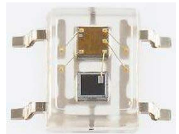
Fotografia 2. Konwerter światło-częstotliwość S9705-01DT marki Hamamatsu (https://t.ly/Dm2A)
