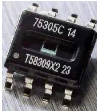
Fotografia 1. Czujnik MLX75305 marki Melexis (https://t.ly/D2AS)
