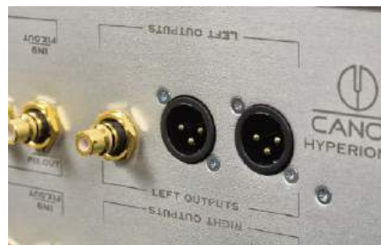
Są aż trzy wyjścia regulowanego sygnału do końcówki, w tym dwa w formule zbalansowanej, co pozwala na bi-amping z końcówkami M1 – wtedy potrzebujemy ich aż czterech.
