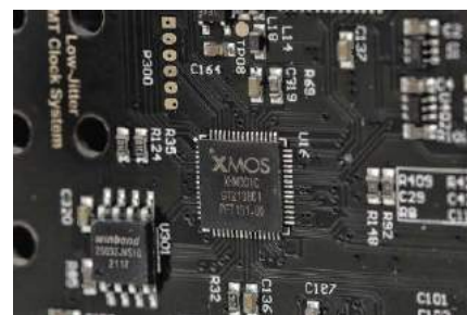
Układ XMOS obsługuje zazwyczaj wejścia USB, tutaj odpowiada też za dodatkowe funkcje, między innymi dekodowanie plików MQA.
