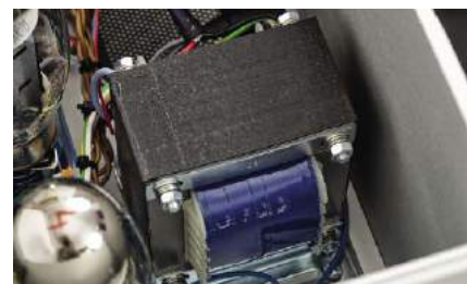
Transformatory głośnikowe to ekskluzywne tzw. transformatory permalojowe
