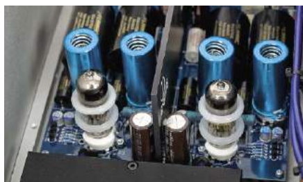
Wzmocnienie jest w pełni lampowe na popularnych triodach 6922 i 6H30.
