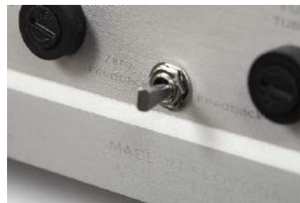
Niespodzianka – przełącznik wyłączający sprzężenie zwrotne. Na pewno każdy tego spróbuje.
