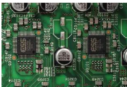
Tandem przetworników C/A ES9026PRO zapewnia wyrubowane parametry wszystkich kanałów formatu 11.4.
