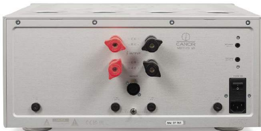
Wejście jest tylko jedno – zbalansowane gniazdo XLR.
