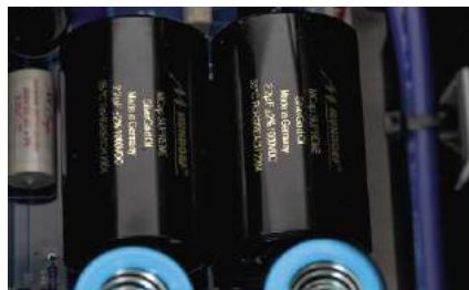
Kondensatory sprzęgające to renomowane Mundorf SilverGold Oil.
