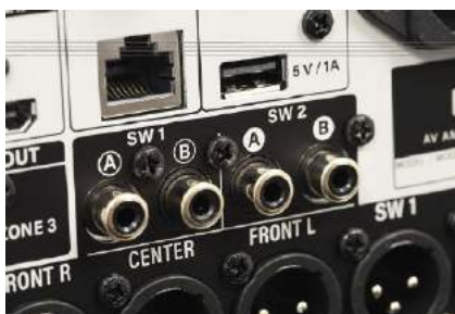
Cztery wyjścia subwooferowe skonfigurowano w dwie pary o niezależnych parametrach.
