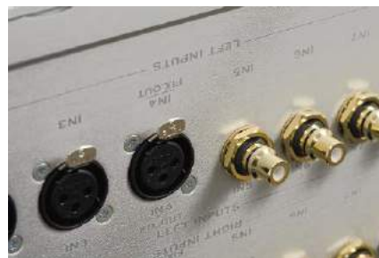
Wyodrębnienie sekcji gniazd kanału lewego i prawego jest pochodną wewnętrznej organizacji i separacji układów.
