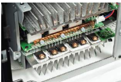
Jedenaście końcówek mocy rozplanowano na czterech radiatorach.
