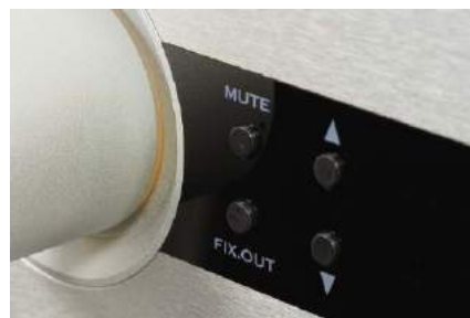
Wybór wejść odbywa się sekwencyjnie, niezależnym przyciskiem wybieramy tryb stałego wzmocnienia (z pominięciem regulacji głośności).
