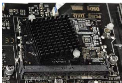
Mózgiem urządzenia (funkcje strumieniowe, zarządzanie obsługą) jest czterordzeniowy procesor w architekturze ARM.
