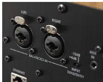
Wejścia zbalansowane w kolumnach aktywnych to wcale nie luksus, lecz dziedzictwo rozwiązań profesjonalnych – długie połączenia wymagają specjalnego traktowania.
