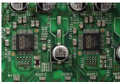
Tandem przetworników C/A ES9026PRO zapewnia wyrubowane parametry wszystkich kanałów formatu 11.4.
