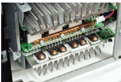
Jedenaście końcówek mocy rozplanowano na czterech radiatorach.
