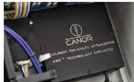
Regulator głośności jest własnym układem firmy Canor, zamkniętym w dodatkowej, wewnętrznej obudowie.
