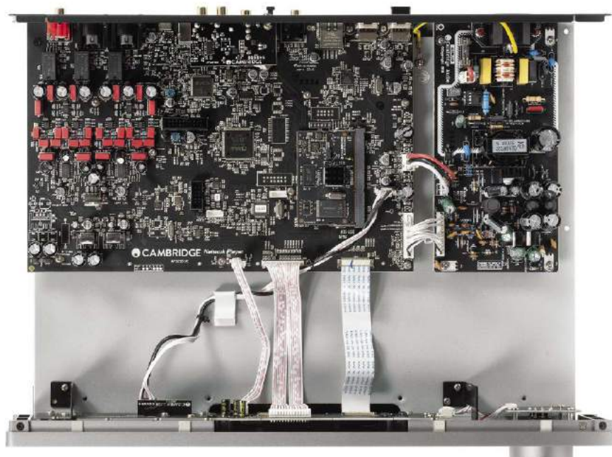
Główna płytką cyfrową jest rozbudowana, ale w dużej obudowie wciąż zostało sporo wolnego miejsca.
