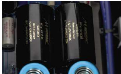
Kondensatory sprzęgające to renomowane Mundorf SilverGold Oil.
