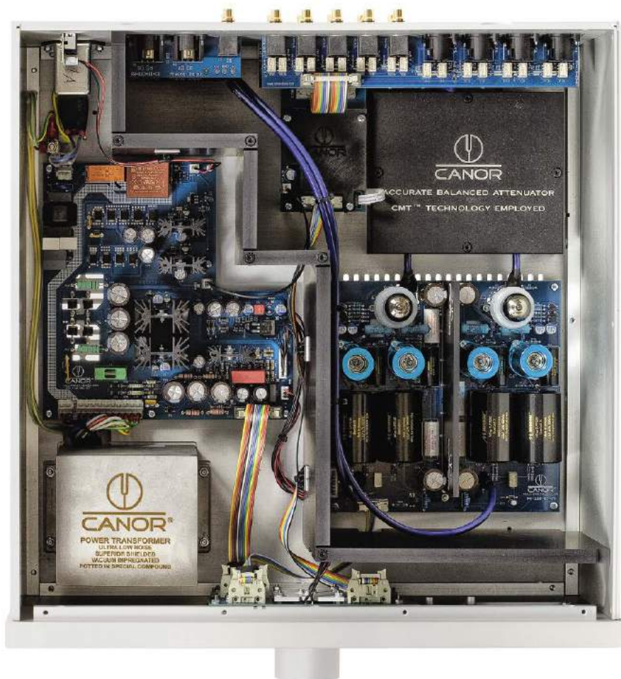
Canor bardzo dba o ekranowanie poszczególnych sekcji – tutaj za pomocą sześćcioelementowej konstrukcji pionowych płyt.
