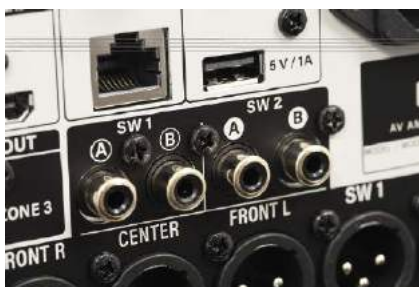
Cztery wyjścia subwooferowe skonfigurowano w dwie pary o niezależnych parametrach.
