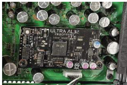
Jednym z najważniejszych „argumentów” Denona jest upsampler Ultra AL32 Processing.
