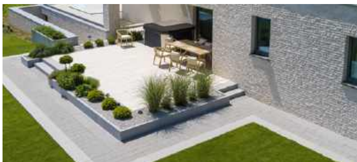
📌 Wygodna wysokość stopni tarasowych to nie więcej niż 17 cm, głębokość – przynajmniej 25 cm. BRUK-BET
