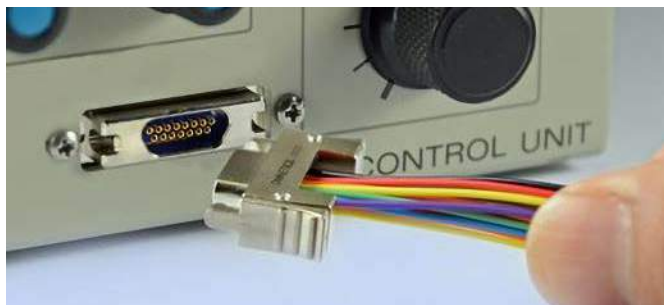
Fotografia 19. Przykładowe złącze typu Nano-D marki Omnetics ( https://t.ly/qnP5 )
