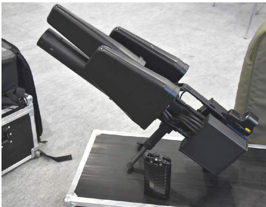
Fotografia 1. Urządzenie EDM4S do zakłócania działania dronów
