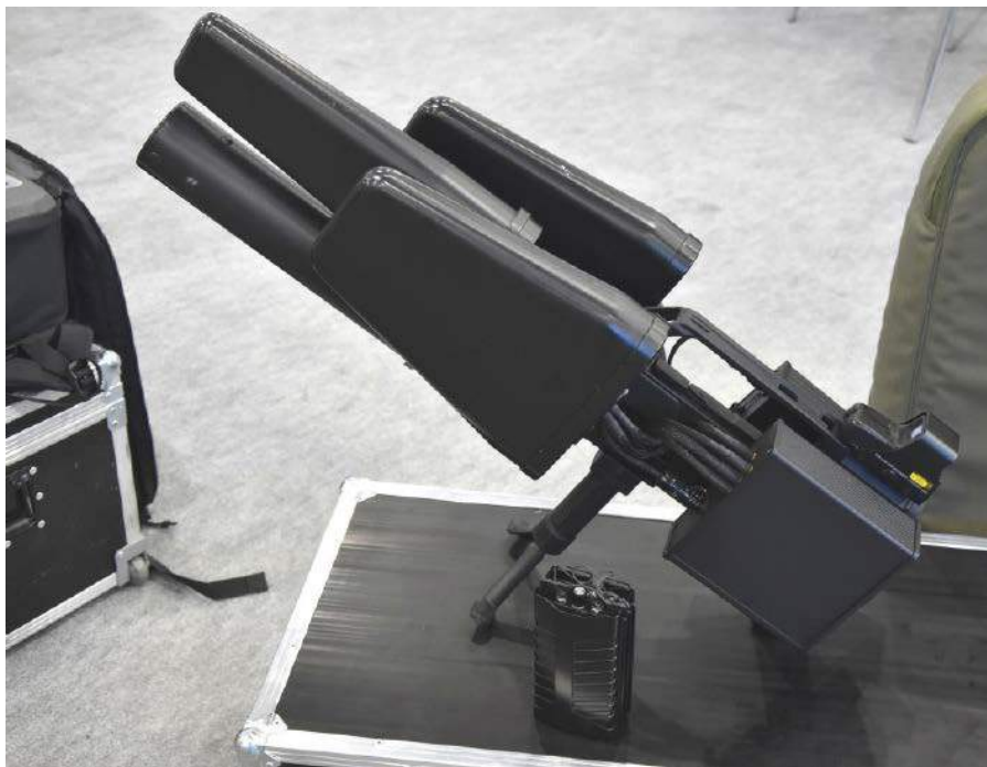
Fotografia 1. Urządzenie EDM4S do zakłócania działania dronów
