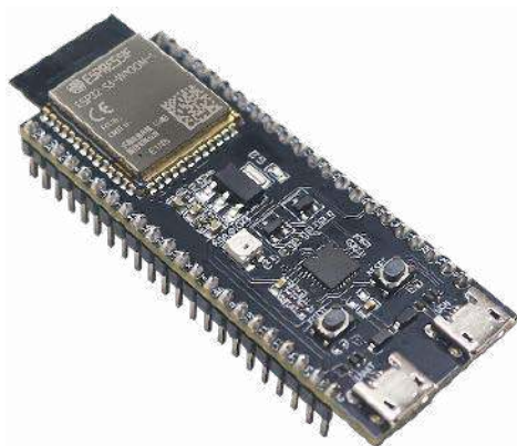
Fotografia 2. Płytki uruchomieniowa ESP32-S3-DevKitC-1 z modułem ESP32-S3-WROOM-1
