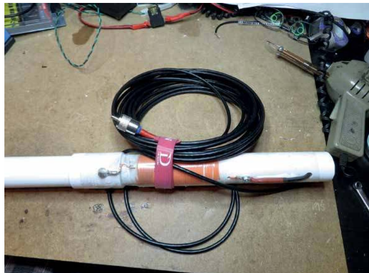
Rys 3. Szkic anteny pojemnościowej
