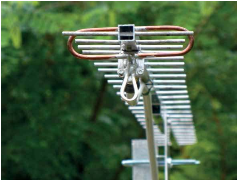
Rys. 5. Sposób wykonania dipola na pasmo 23 cm
