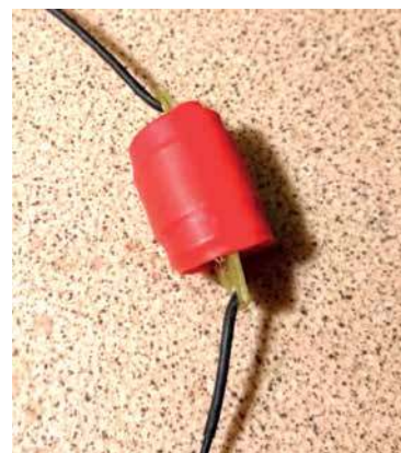
Rys. 2. Schemat jednej z wersji trapy anteny
