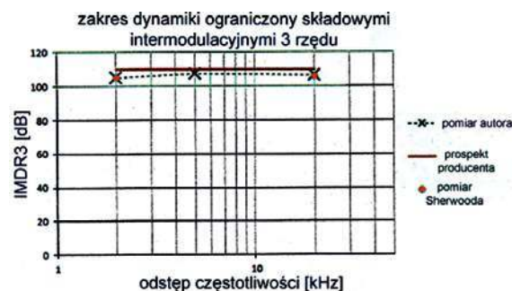
Rys. 3. Pomiary zakresu dynamiki ograniczonego składowymi intermodulacyjnymi wykazują daleko idącą zgodność
