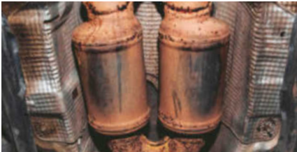
BEZPROBLEMOWY UKŁAD GPF , za to nie wytrzymał katalizator. Zamienniki nie zdają egzaminu, zdecydowano się na regenerację.
