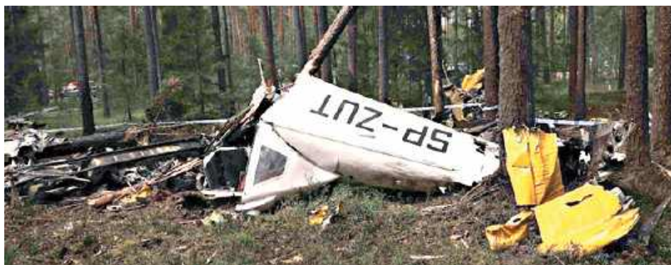
Samolot, ścinając wierzchołki drzew, o godzinie 20.40 zderzył się z ziemią. Nastąpił zapłon paliwa wyciekającego z rozerwanym zbiorników
