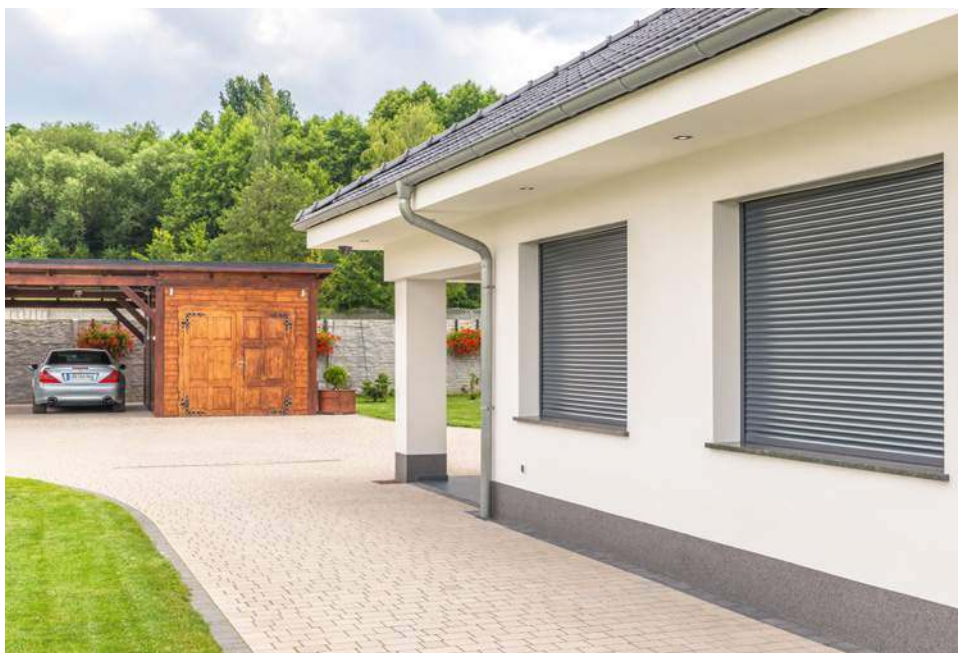
🔗 O roletach zewnętrznych należy pomyśleć już na etapie stanu surowego, bo niektóre modele wymagają specjalnego przygotowania otworu okiennego. KRISPOL
