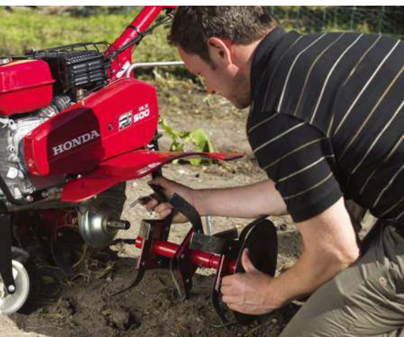
🔧 Podczas przeglądu glebogryzarki należy usunąć resztki ziemi z noża i obudowy przekładni. HONDA
