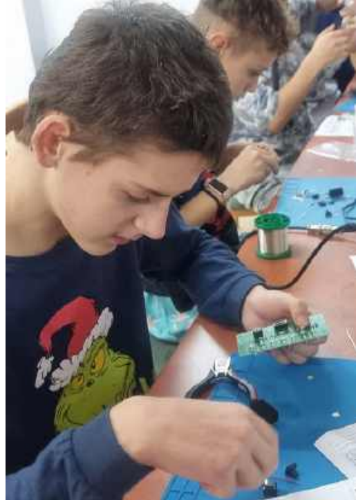
Fotografia 9. Kornel powoli kończy montaż układu. Do przylutowania zostały jeszcze dwa przełączniki. Młodzi Entuzjaści Elektroniki, Szkoła Podstawowa nr 86, Wrocław
