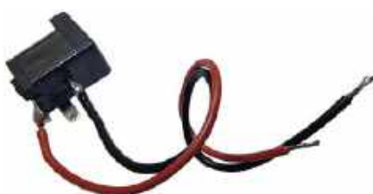
Fotografia 18. Gniazdo baryłkowe z przyłutowanymi kabelkami. Kabelki czerwony (plus) przyłutowany do blaszki na tyle gniazda, kabelki czarny (minus) do blaszki na spodzie gniazda. Boczna blaszka pozostaje nielutowana
