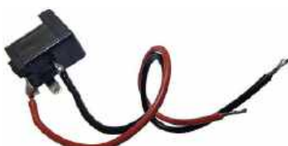
Fotografia 18. Gniazdo baryłkowe z przyłutowanymi kabelkami. Kabelki czerwony (plus) przyłutowany do blaszki na tyle gniazda, kabelki czarny (minus) do blaszki na spodzie gniazda. Boczna blaszka pozostaje nielutowana
