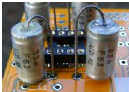
Rysunek 16. Na płytkach filtrów jest wystarczająco dużo miejsca, aby dać kondensatory polistyrenowe o tolerancji 1% – o ile uda się je zdobyć. Do filtrów elektroakustycznych doskonale nadawały się kondensatory Philips z serii 424, ale zostały wycofane z produkcji, ponieważ ich dielektryk zawierał neurotoksyczny ołów
