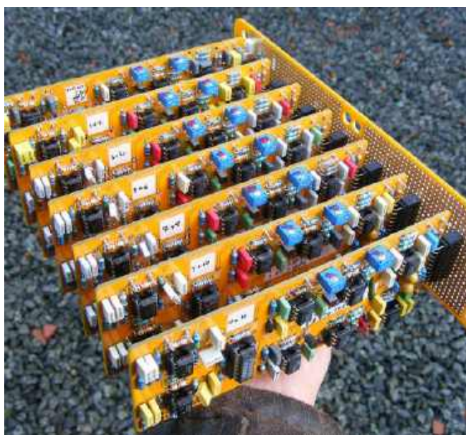
Rysunek 1. Serce wokodera – sześć płytek z filtrami pasmowoprzepustowymi i płytka górno-/ dolnoprzepustowa. Wszystko podłączone do magistrali
