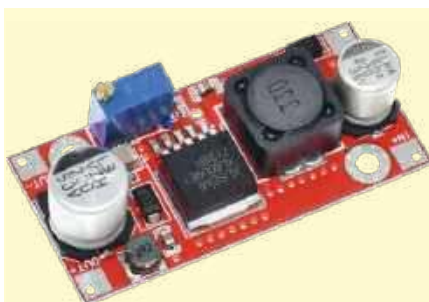
Moduły z chipem XL6009 występują w kilku różnych wersjach. Widoczny tu, naszym zdaniem działa najlepiej i jest całkiem niedrogi. Będzie on również dostarczany jako część kompletnego zestawu dla płytki sterownika
