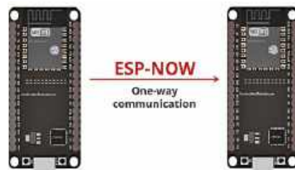
Rysunek 6. Jednokierunkowa komunikacja między modułami ESP32
