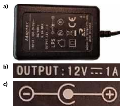
Rysunek 4. Na tabliczce znamionowej a) przykładowego zasilacza, b) widoczny jest napis informujący o tym, że zasilacz ten dostarcza (output) napięcie stałe (symbol podobny do znaku równości z przerywaną dolną linią) o wartości 12 V przy dopuszczalnym natężeniu prądu obciążenia o wartości 1 A oraz c) rysunek pokazujący schemat polaryzacji na wtyczce („plus” wewnątrz i „minus” na zewnątrz). Zasilacz na napięcie 12 V bezpośrednio nie nada się do zasilania naszych układów z mikrokontrolerami
