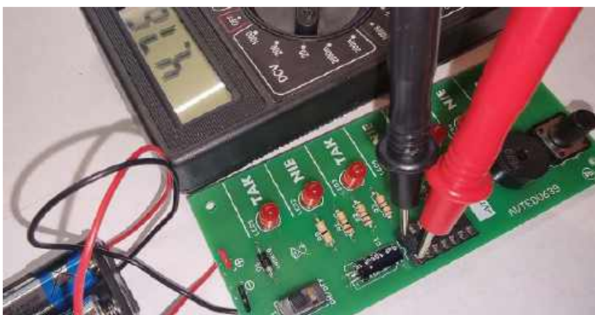
Fotografia 14. Po ustawieniu przetłacznika SW1 w pozycji ON (hebelki w stronę najbliższej krawędzi PCB) pomiędzy pinem pierwszym (plus zasilania) oraz czternastym (minus zasilania) powinno znajdować się napięcie nieco poniżej 5 V
