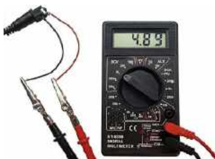
Fotografia 19. Pomiar napięcia na końcach kabelków. Ponownie zmierzono napięcie około 4,9 V a brak znaku przed liczbą świadczy o prawidłowej polaryzacji (plus na czerwonym kabelku). Zwróć też uwagę na zastosowane krokodylki nałożone na sondy przyrządu pomiarowego, które bardzo ułatwiają codzienną pracę
