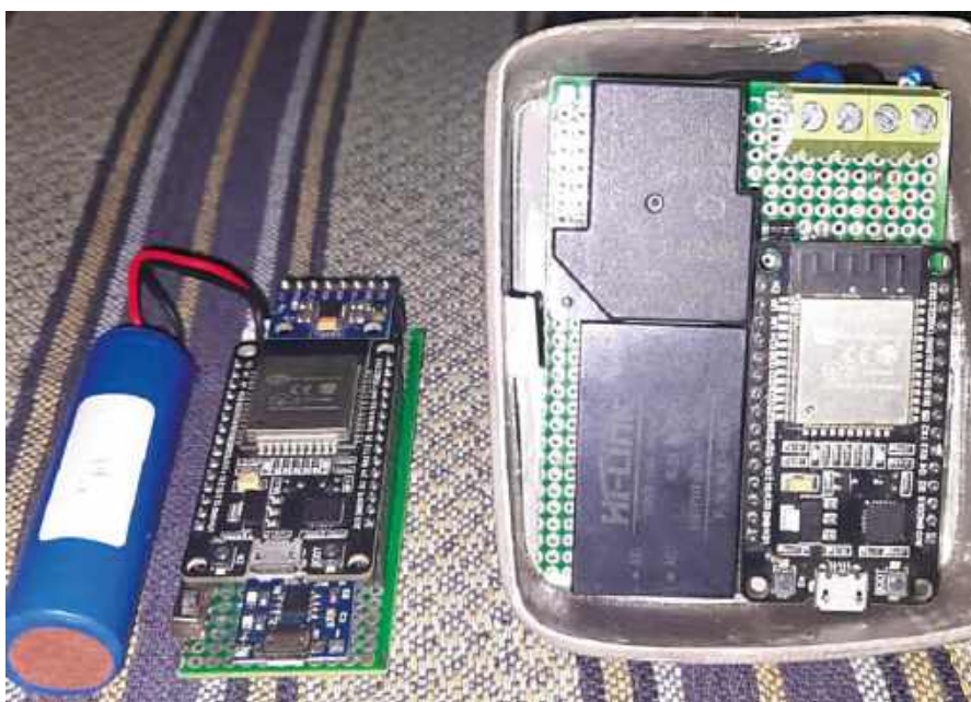
Rysunek 1. Prototyp wykonany przez autora (po lewej – część nadawcza; po prawej stronie – odbiornik i wykonawcza jednostka centralna)
