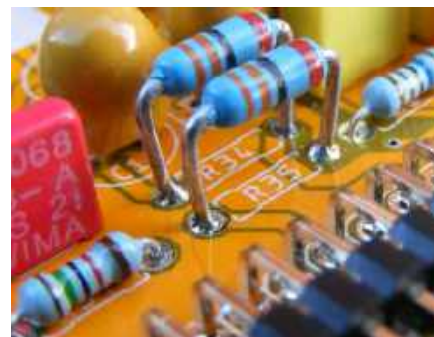
Rysunek 10. Rezystory R34 i R35 doprowadzające zasilanie powinny być montowane ponad płytką, bo w razie awarii mogą się mocno nagrzewać
