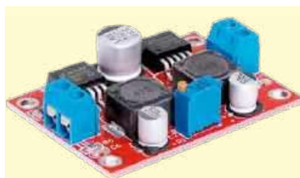
W module Altronics Z6337 buck-boost są zastosowane dwa układy scalone sterownika i dwie cewki. Uzyskano dzięki temu oddzielne funkcje buck i boost. Mini LED Driver jest przeznaczony do użyciu z modułem boost-only
