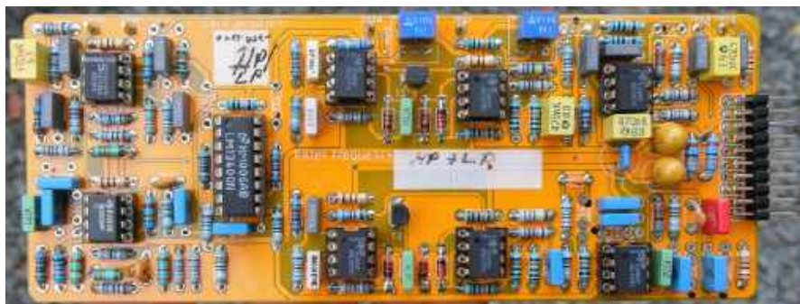
Rysunek 9. W pełni zmontowana płytka „HP/LP”. Jest to wersja wcześniejsza z dodanymi kilkoma elementami do celów eksperymentalnych. Wszystkie płytki sprzedawane przez Practical Electronics są dokładnie zgodne z rysunkami montażowymi
