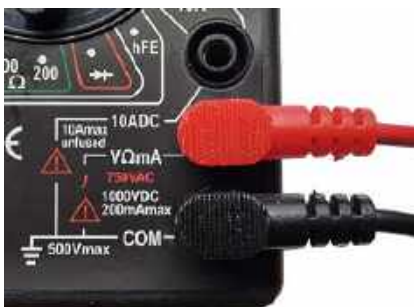
Fotografia 13. Poprawne podłączenie przewodów na przykładzie multimetru DT-830B ustawionego na funkcję woltomierza napięć stałych. Wolne gniazdo „10 ADC” używane jest wyłącznie do pomiarów prądów w przedziale od 200 mA do maksymalnie 10 A. Oznacza to, że widoczne na zdjęciu podłączenie kabli poprawne jest dla większości wykonywanych na co dzień pomiarów (pomiar ciągłości, omomierz, woltomierz, i amperomierz – ten ostatni wyłącznie w zakresie do 200 mA)
