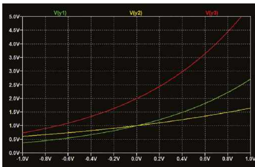
Rysunek 1. Idealne wykładnicze (antylogarytmiczne) zależności wejście-wyjście: funkcja nieskalowana (/zielony), wejście skalowane przez 0,5 (/żółty) i wyjście skalowane przez 2 (/czerwony)
