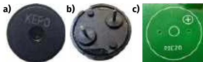
Fotografia 8 a) i b) – brak oznaczeń polaryzacji na pasywnym buzzersie piezo dołączonym do zestawu, c) znacznik polaryzacji na płytce PCB na wypadek potrzeby użycia bardziej egzotycznego pasywnego buzzera
