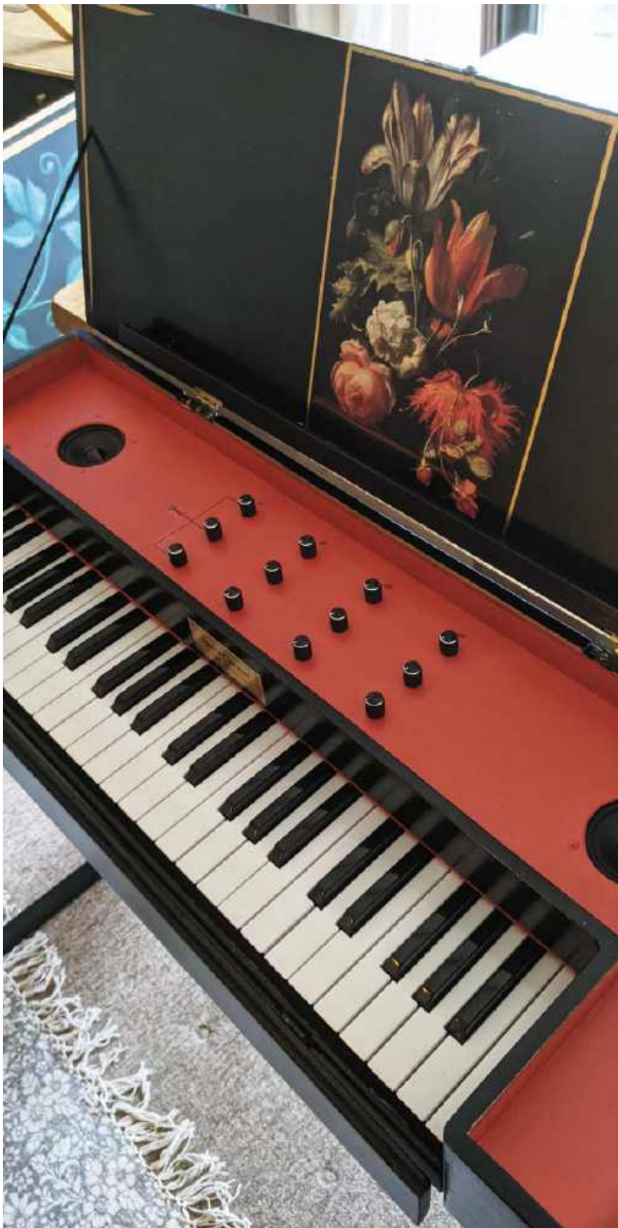
Rysunek 13. Syntezator MIDI został połączony ze standardową klawiaturą kontrolera MIDI, wzmacniaczem i głośnikami, tworząc ten elektroniczny klawikord
