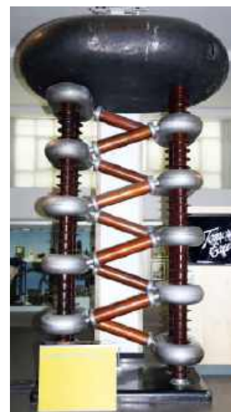
14. Generator Cockcrofta-Waltona zbudowany przez firmę Philips w 1937 roku (© 2012 Wikimedia Commons – Geni)
