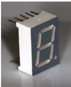
Rysunek 2. Klasyczny 7-segmentowy wyświetlacz LED
