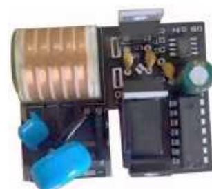
12. Generator 20 kV do zasilania generatora Cockcrofta-Waltona (© AliExpress)
