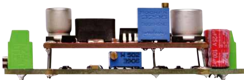
Wyraźnie widać przewód od nóżki FBPIN do potencjometru powyżej
