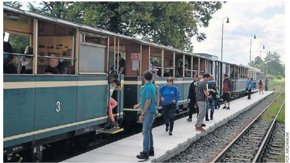
Pomiędzy tory wystarczy włożyć trzecią szynę, dostosowaną do rozstawu kół wąskotorówki i zabytkowy pociąg z Osoblahy pojedzie kilka kilometrów do Polski.
