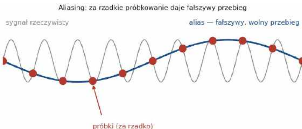
Rysunek 6. Aliasing: gdy na okres sygnału przypadają mniej niż dwie próbki, próbki szybkiego przebiegu (szary) układają się w wolny, nieistniejący przebieg (niebieski) – alias. Dlatego pomiar częstotliwości z niedoprobkowanego sygnału potrafi mocno mylić
