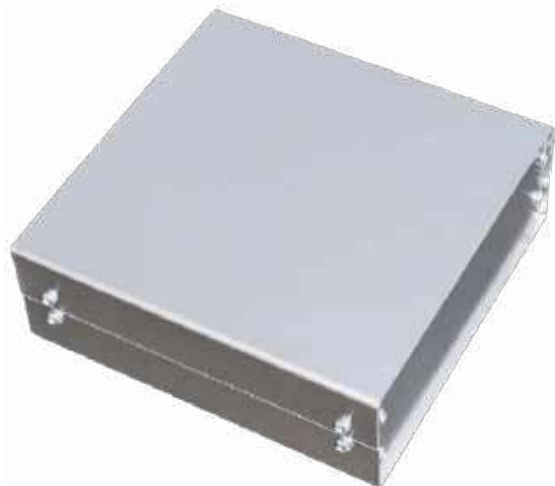
Fotografia 13. Obudowa z profilu aluminiowego – konstrukcja zapewniająca ciągłość ekranu na trzech ściankach przy jednoczesnym odprowadzaniu ciepła
