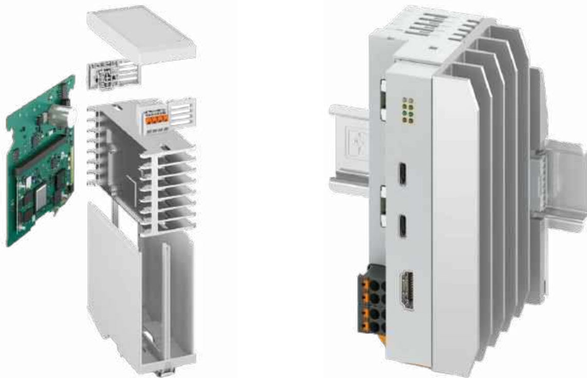
Fotografia 7. Obudowa na szynę DIN z aluminium radiatorem zintegrowanym z korpusem, przeznaczona do modułów o podwyższonej mocy strat
