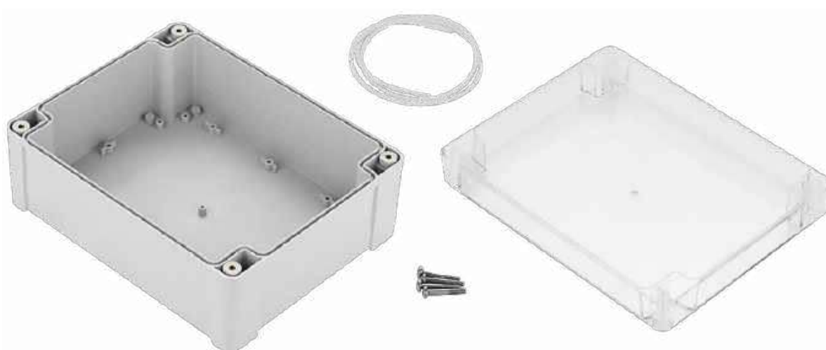
Fotografia 5. Obudowa hermetyczna z poliwęglanu z przezroczystą pokrywą i uszczelką obwodową, w wykonaniu IP65/IK07
