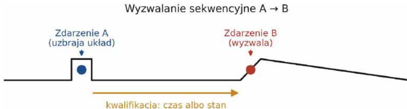
Rysunek 3. Wyzwalanie sekwencyjne: zdarzenie A uzbraja układ, a dopiero zdarzenie B – po spełnieniu warunku czasu lub stanu – wyzwala zapis
