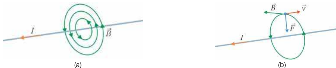
Rysunek 7. (a) Przykładowe linie pola magnetycznego powstające wokół nieskończonego prostoliniowego przewodnika, w którym płynie prąd elektryczny. (b) Na ładunek ujemny poruszający się z prędkością równoległą do przewodnika, w którym płynie prąd elektryczny w kierunku zgodnym z kierunkiem dryfu elektronowego (przeciwnym do kierunku prądu elektrycznego) działa siła skierowana do przewodnika.
