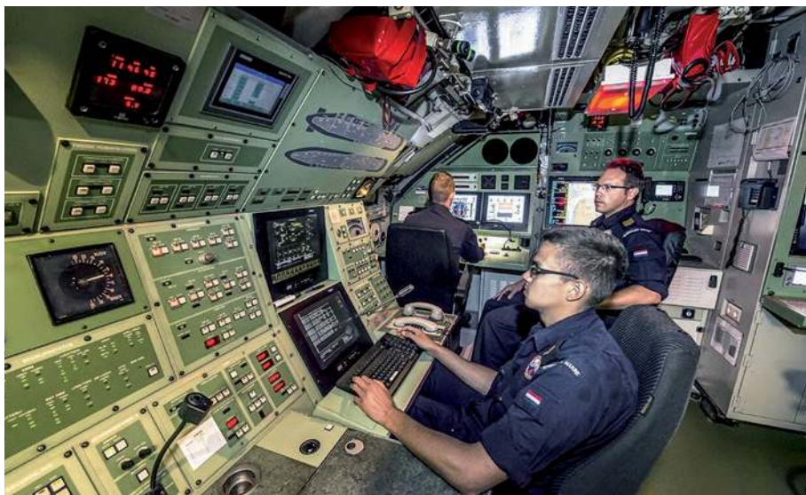
▲ Centrum sterowania siłownią na okręcie podwodnym typu Walrus/Zeeleeuw , operującego na głębokości (według wskazania głębokościomierza) 173 m. Połączenie kadłuba i rozmiarów jednostki klasy SSN z napędem konwencjonalnym wydaje się kluczowym wyzwaniem w programie Orka .
