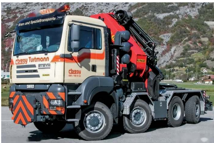
▲ Steyr, czyli MAN TG skompletowany w zakładach w Wiedniu. Niemiecki koncern także może dostarczyć wysoce manewrowe, terenowe podwozia. Egzemplarz na zdjęciu powstał dla sektora energetycznego, ale bez problemu może służyć jako nośnik ciężkiej terenowej wywrotki. Wymagać to jednak będzie zwiększenia rozstawu osi 2-3.
