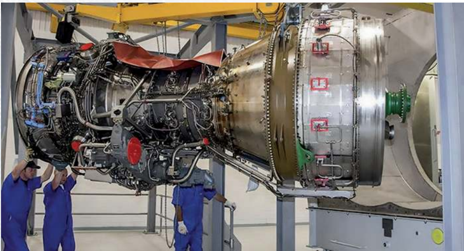
▲ Lotnicza turbina gazowa General Electric LM2500 adaptowana do zastosowań morskich.
