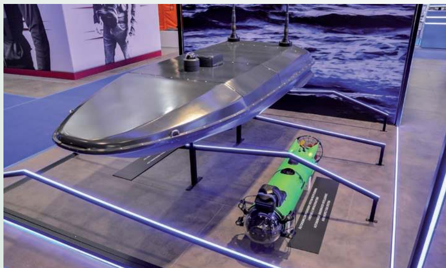
▲ Środek nawodny Sk@rp przeznaczony do symulacji działań dronów uderzeniowych i autonomiczny podwodny system rozpoznania i inspekcji infrastruktury Pirania .
