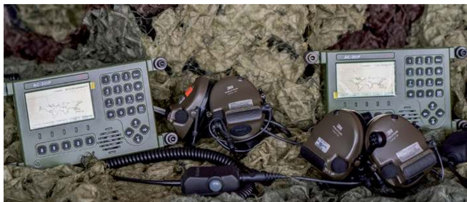
▲ Pulpity łączności Cyfrowej AC-30IP zapewniają łączność foniczną z wykorzystaniem interkomu oraz technologii Voice over IP (VoIP), umożliwiając komunikację pokładową pomiędzy członkami załogi oraz łączność zewnętrzną za pośrednictwem radiostacji pokładowej. Mogą pełnić funkcję terminali do prezentacji informacji operacyjnych, alarmów oraz sygnalizacji zagrożeń, w tym komunikatów o wykryciu skażeń, a także danych pochodzących z innych systemów pojazdu.
