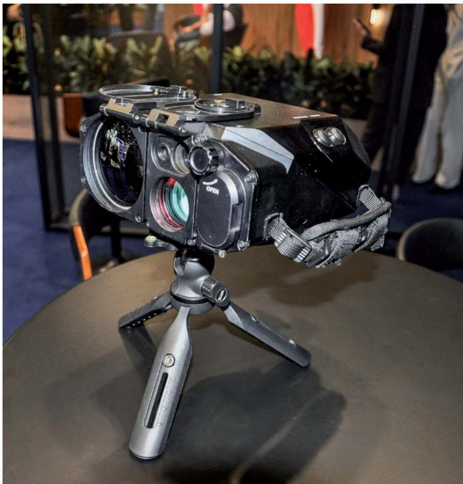
▲ Przeznaczona do obserwacji przez całą dobę czy określania współrzędnych celów i przekazywania ich bezpośrednio na stanowiska dowodzenia jednookularowa lornetka Wolt-1.
