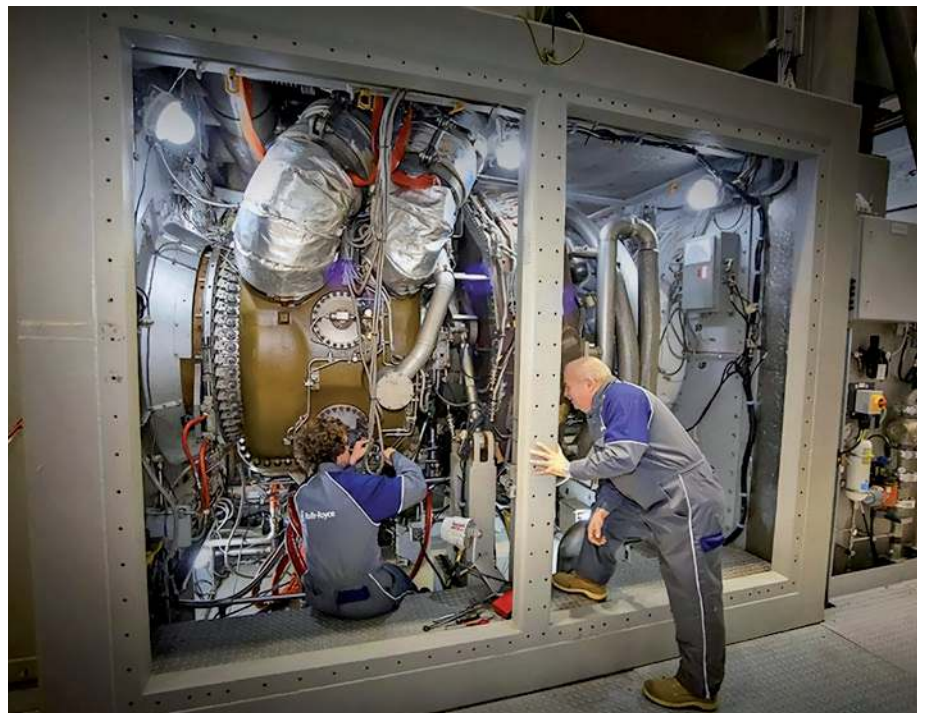
▲ Modułowa turbina gazowa Rolls-Royce Marine Trent – przykład nowoczesnego napędu wysokiej sprawności przeznaczonego dla większych okrętów uderzeniowych.
