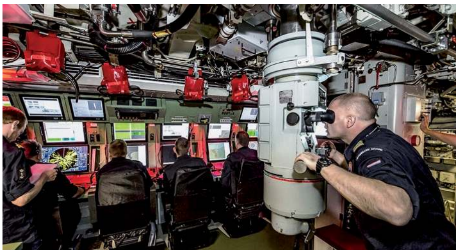
▲ Wnętrze zmodernizowanego głównego stanowiska dowodzenia (centrali) na okręcie podwodnym typu Walrus/Zeeleeuw . Współczesne okręty to mobilne centra przetwarzania danych z różnych sensorów (źródeł), co wymusza określone wymagania w zakresie integracji i zabezpieczenia źródeł energii.
