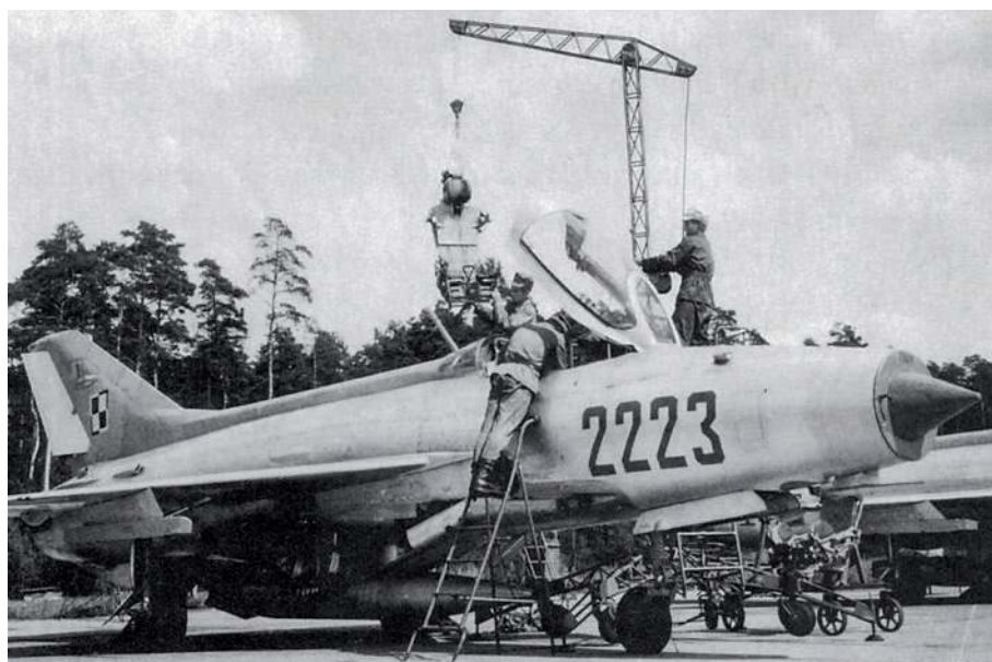
▲ Ciekawe ujęcie montażu w kabinie MiG-21F-13 fotela katapultowego SK-1.
