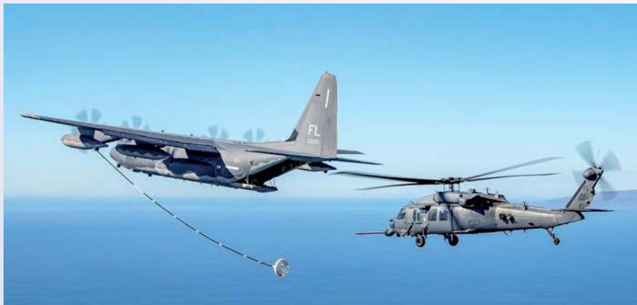
▲ Jedną z poważniejszych słabości śmigłowców przeznaczonych do Combat SAR jest niewystarczający zasięg lotu w trakcie misji prowadzonych często w głębi terytorium przeciwnika. Dlatego w porównaniu do bazowego UH-60M na HH-60W zwiększona została objętość zbiorników paliwa. Śmigłowiec otrzymał również sondę do tankowania w powietrzu.
