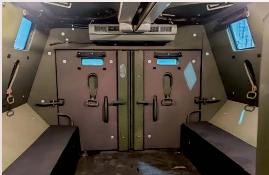
► Aranżacja przedziału desantowego Czekana odpowiada standardom sprzed kilku dekad – żadnych siedzisk przeciwybuchowych, tylko proste ławki ustawione wzdłuż burt.
