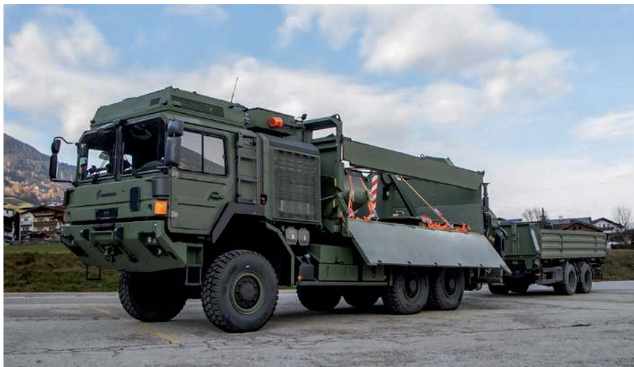
▲ Przy wyborze ładowność pełniła funkcję wtórną, a podwozie 3-osiowe o dopuszczalnej masie całkowitej 28 000 kg oznaczało, iż w niewielkim stopniu będzie obciążać wysokogórskie szlaki i obiekty inżynierskie, takie jak drogi oraz wiadukty i mosty.
