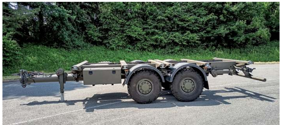
▲ Kolejny ciekawy produkt Tatry stanowi terenowa przyczepa o masie całkowitej 18 000-20 000 kg i ładowności - jako wywrotka skalna - rzędu 12 000-13 000 kg, w tym także w warunkach terenowych.
