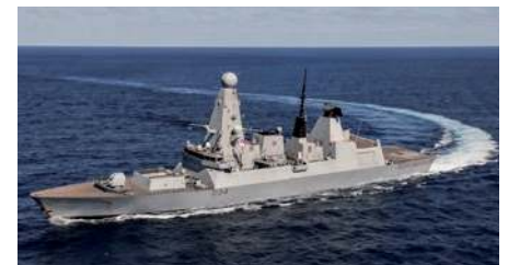
▲ Brytyjski niszczyciel rakietowy typu Daring (projektu 45) to typowy okręt wykorzystujący zintegrowany elektryczny system napędowy IFEP.
