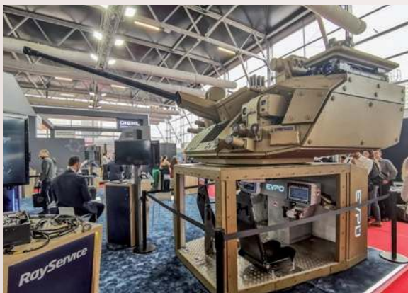
▲ Najnowsza odsłona wieży Turra 30 , czyli pokazana między innymi na MSPO 2025 jej wersja 10. Dobrze widoczna kluczowa zmiana w stosunku do poprzednika, którą jest chowana w korpusie wieży i unoszona wyrzutnia ppk.
